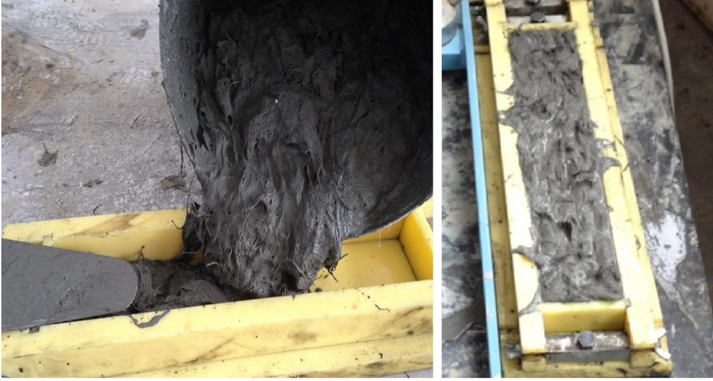
Şekil 4.8. SIFCON 'un kalıba yerleştirilmesi ve vibrasyon işlemine tabi tutulması
