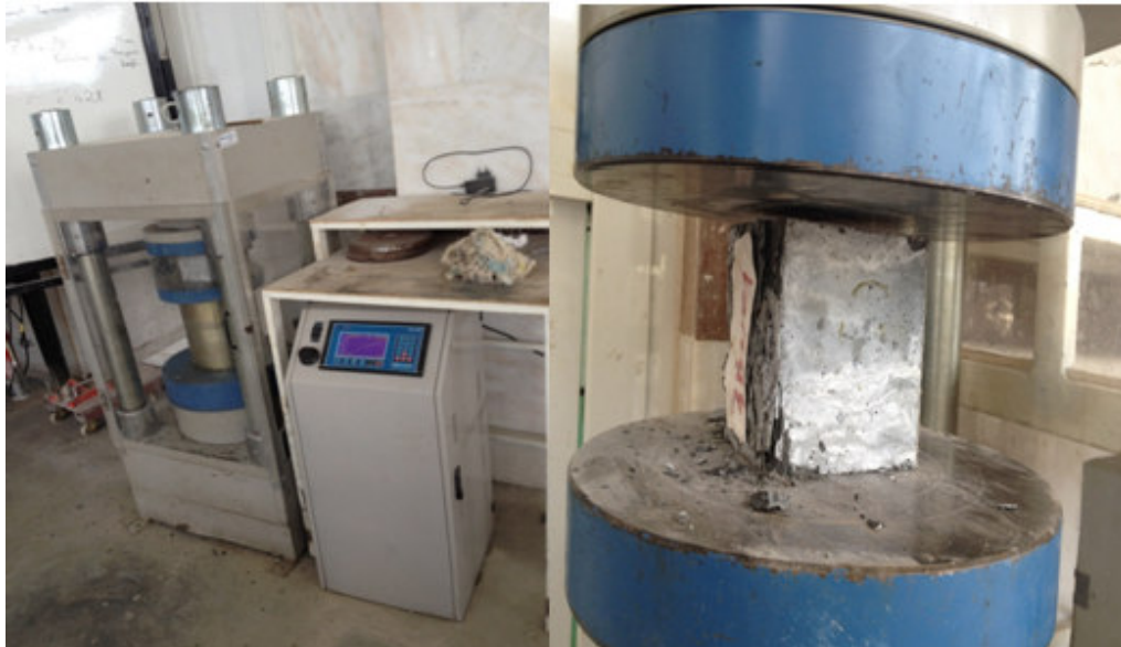
Şekil 4.12. Beton basınç dayanımı deneyi
