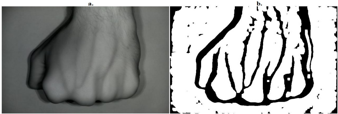
Şekil 4.6. a) Kamera tarafından alınan görüntünün orjinal hali b) RPi 2 mikrobilgisayarında işlenmiş son hali
