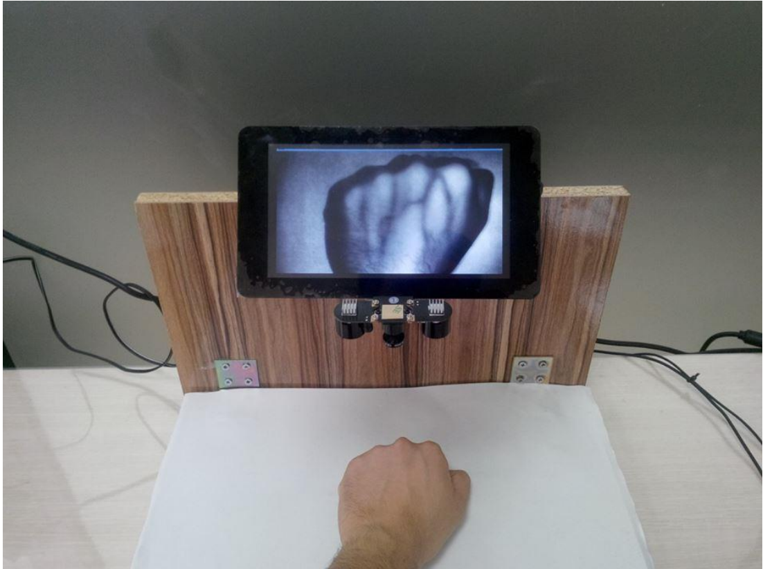
Şekil 3.21. Kurulu olan damar görüntüleme sistemi ve deneklerden el görüntüsü toplanma aşaması
