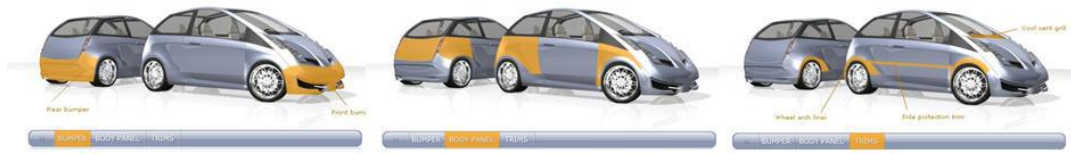
Şekil 3.9. Standart Bir Aracın Gövde ve Dış Giydirmesi (Tampon, Gövde Panelleri ve Süsleme/Kapama Elemanları) [35]
