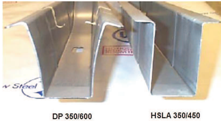
Şekil 2.1. Farklı malzemeler ile aynı kalıpta basılmış sac parçalar [3]
