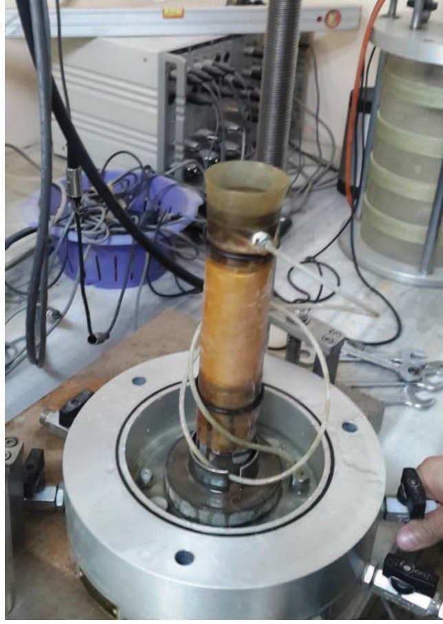
Foto 3.4. CTX deney cihazına yerleştirilmiş deney numunesi
