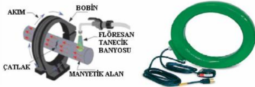
Şekil 5.7. Bobin tipi manyetikleme cihazı [66].
