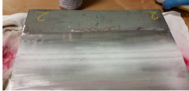
Şekil 6.7. Penetrant geliştiricinin uygulanması.
