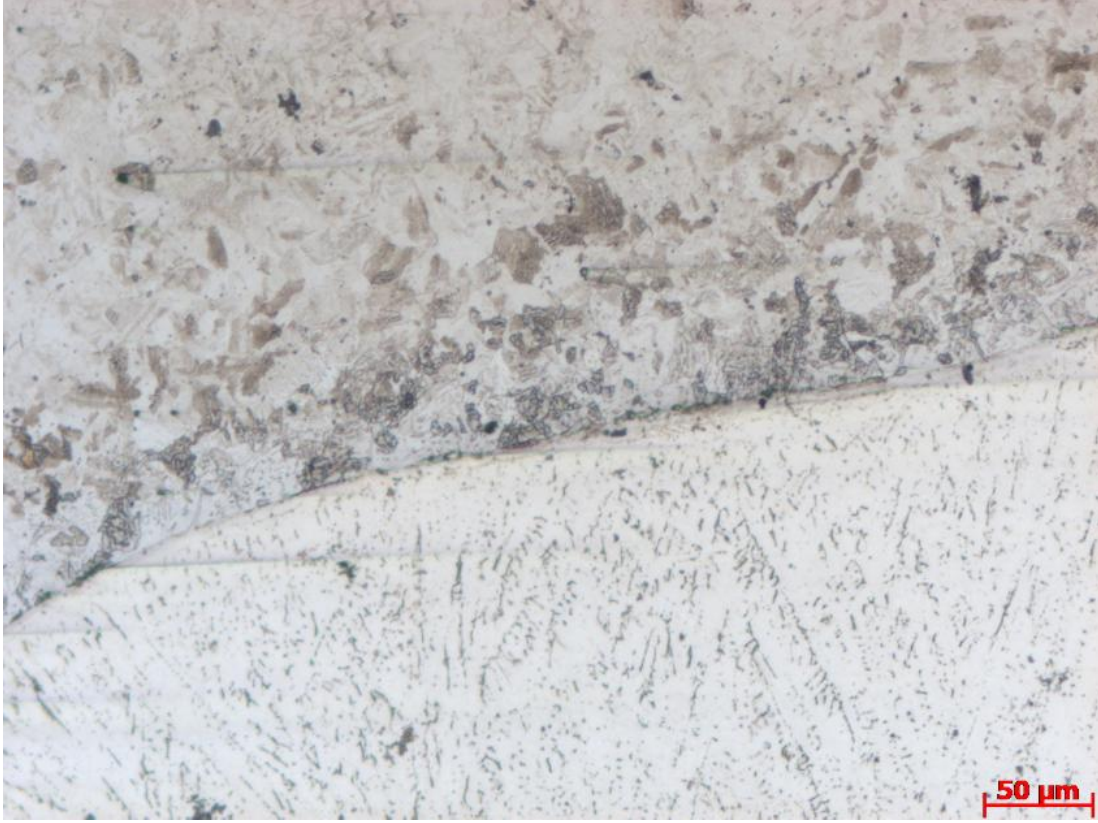
Şekil 7.46. 2 nolu numune sol kök ITAB bölgesi 200X mikro görüntüsü.
