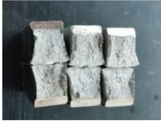
Şekil 7.18. 2 numaralı numune kaynak metal bölgesi kırılma yüzeyleri.
