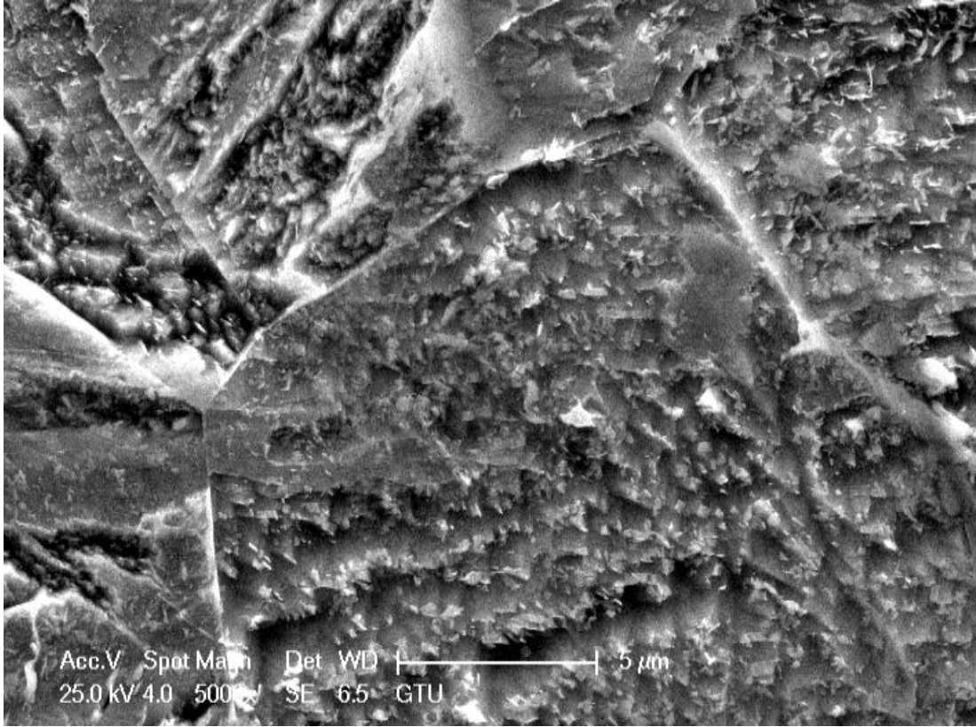
Şekil 7.62. 2 nolu numune ana malzeme bölgesi 5000X SEM görüntüsü.
