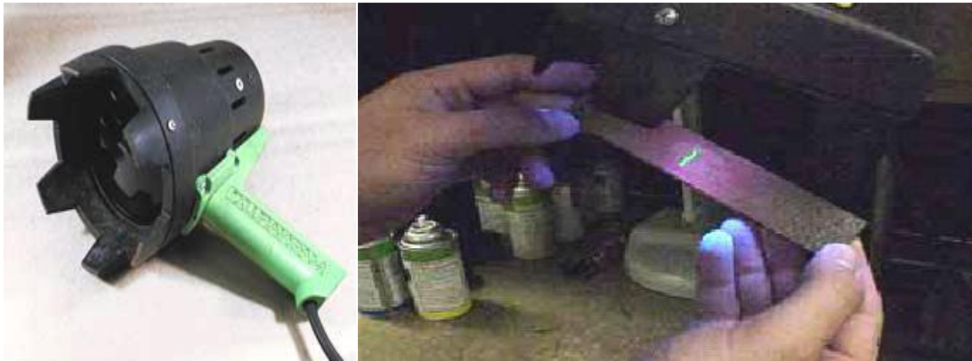
Şekil 5.4. Flor ışık penetrant yöntemi [65].
