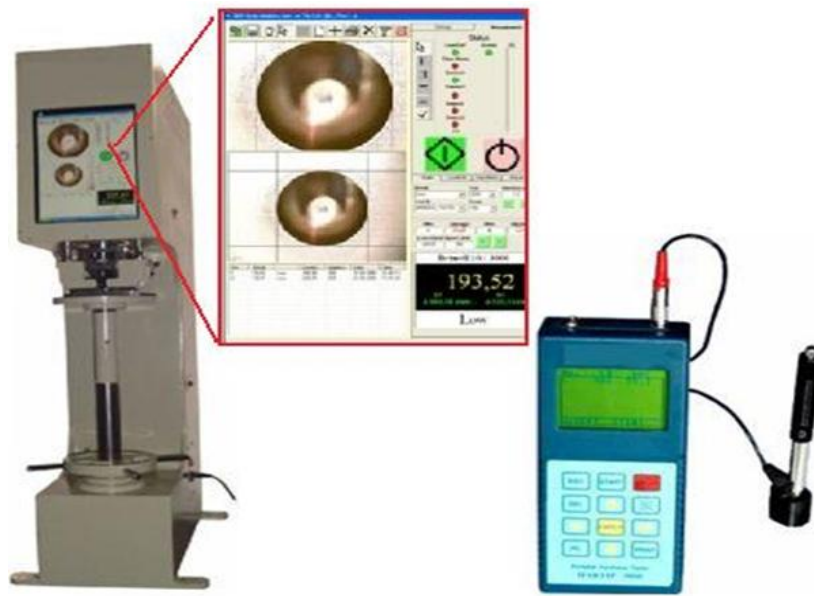
Şekil 5.52. Sabit ve portatif sertlik test cihazları [84].
