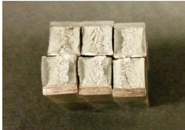
Şekil 7.13. 1 numaralı numune ısı tesiri altında kalmış bölge kırılma yüzeyleri.
