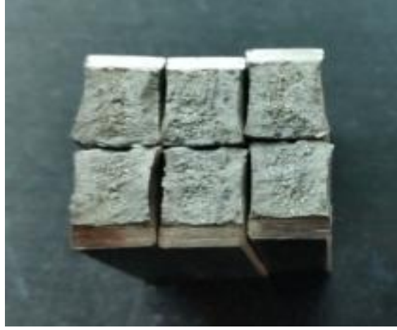
Şekil 7.17. 2 numaralı numune ergime hattı kırılma yüzeyleri.
