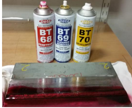
Şekil 6.6. Penetrant sıvısının uygulanması.
