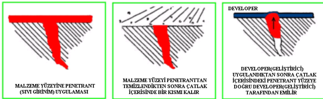
Şekil 5.3. Penetrant muayene işlem sırası [65].
