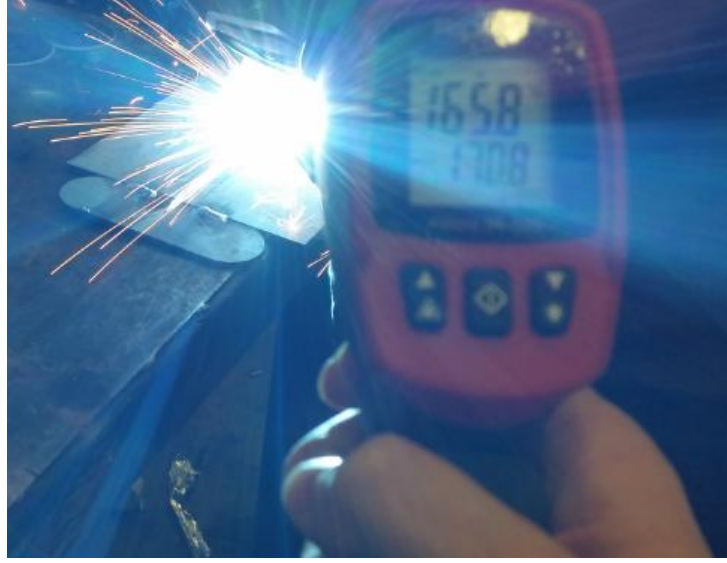
Şekil 6.4. Kaynak sırasında yapılan sıcaklık kontrolleri.
