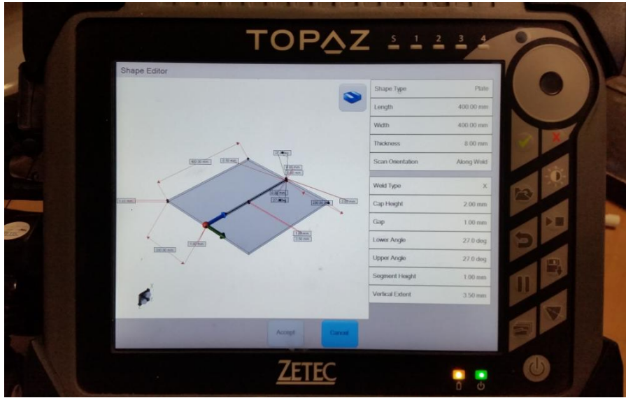
Şekil 6.11. Test parçasının fiziksel özelliklerinin cihaza tanıtılması.
