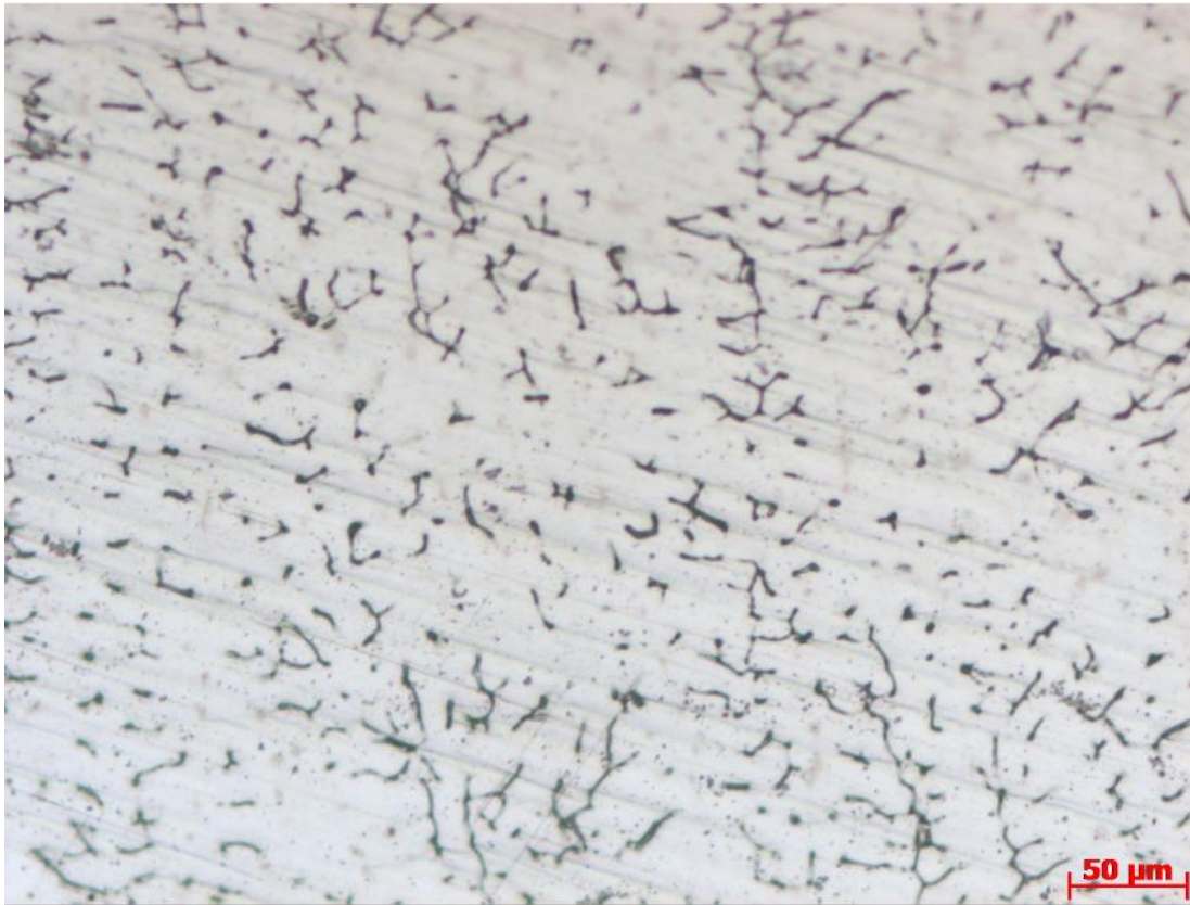
Şekil 7.37. 2 nolu numune kaynak kepi bölgesi kaynak metali 200X mikro görüntüsü.
