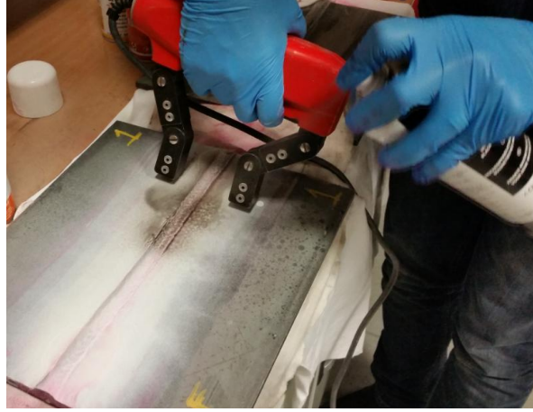
Şekil 6.8. Manyetik parçacık testi uygulanması.
