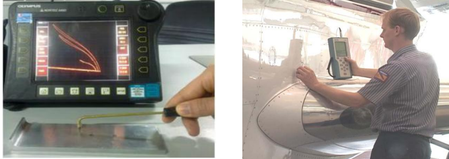
Şekil 5.13. Girdap akımlarıyla muayene [65].
