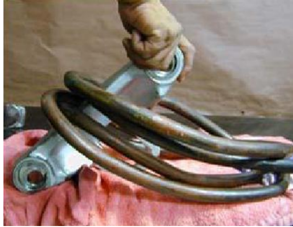
Şekil 5.9. Bağlantılı bobinle manyetik muayene [65].
