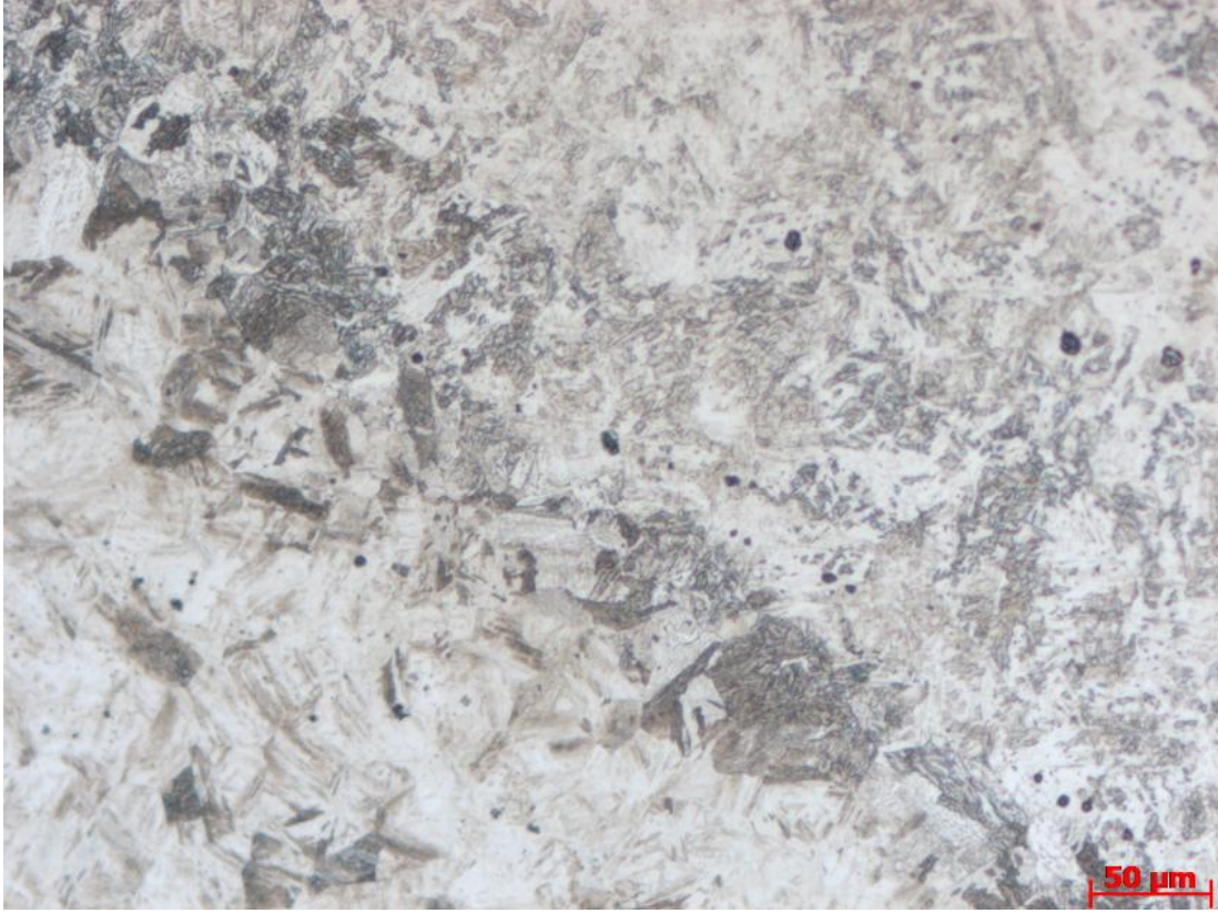
Şekil 7.33. 1 nolu numune sol kep ITAB bölgesi 200X mikro görüntüsü.
