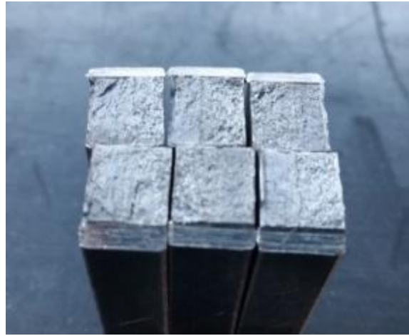
Şekil 7.16. 2 numaralı numune ısı tesiri altında kalmış bölge kırılma yüzeyleri.
