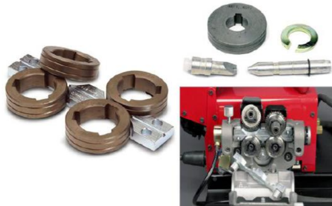
Şekil 4.10. Tel sürme ünitesi [47].
