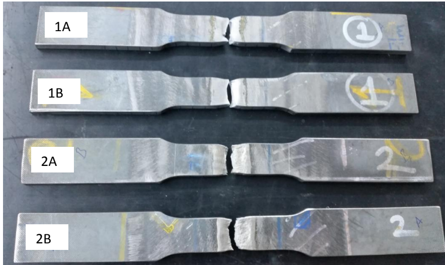
Şekil 7.6. Çekme testi numunelerinin test sonrası görüntüleri.
