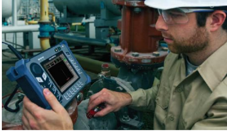
Şekil 5.23. Ultrasonik muayenenin yapılışı [65].
