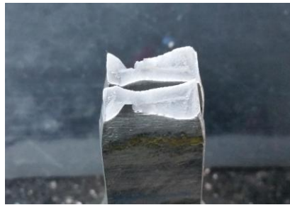
Şekil 7.7. 1 numaralı numune A parçası kopma yüzeyi.
