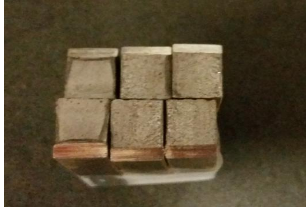
Şekil 7.14. 1 numaralı numune ergime hattı kırılma yüzeyleri.
