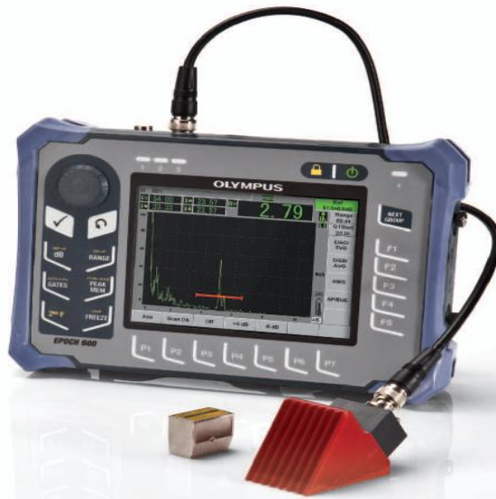
Şekil 5.20. Ultrasonik cihazı ve problemleri [80].
