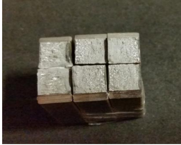
Şekil 7.15. 1 numaralı numune kaynak metalı bölgesi kırılma yüzeyleri.
