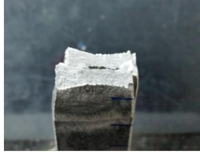
Şekil 7.9. 2 numaralı numune A parçası kopma yüzeyi.
