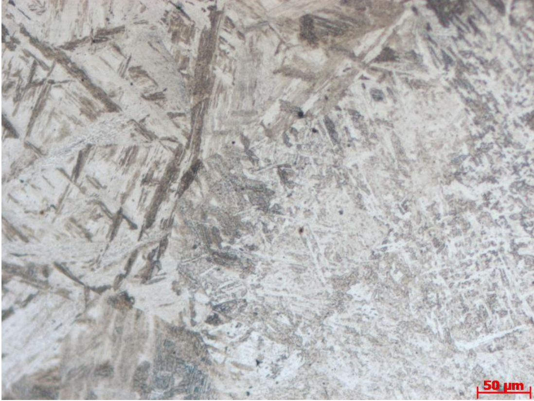
Şekil 7.35. 1 nolu numune sol kök ITAB bölgesi 200X mikro görüntüsü.
