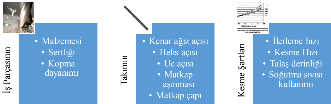
Şekil 3.7. Delme kuvvetleri etkileyen kuvvetler (El-Hofy, 2013)
