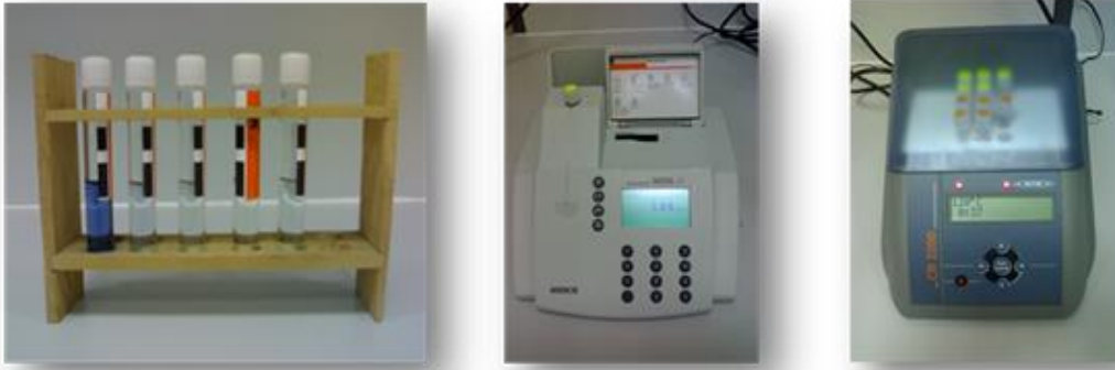
Şekil 3.5. Merck Test Kitleri, Merck Nova 60 Spektrofotometre, Termoreaktör (WTW CR 4200 ve CR 2010-Germany)
