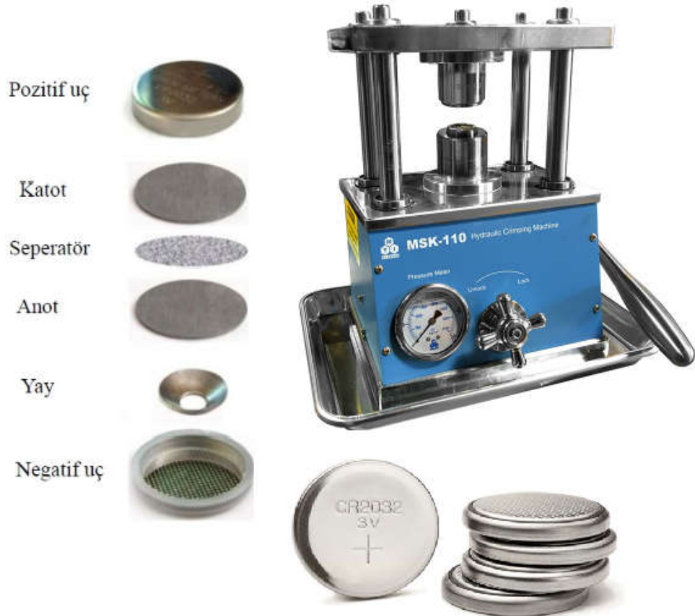
Şekil 4.7. CR2016 tipi düğme pil ve montajı
