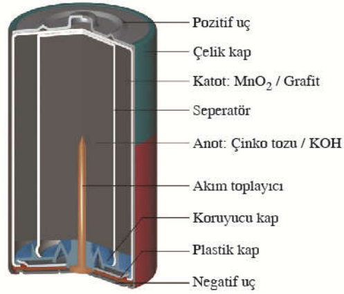
Şekil 2.10. Alkalin pilin yapısı
