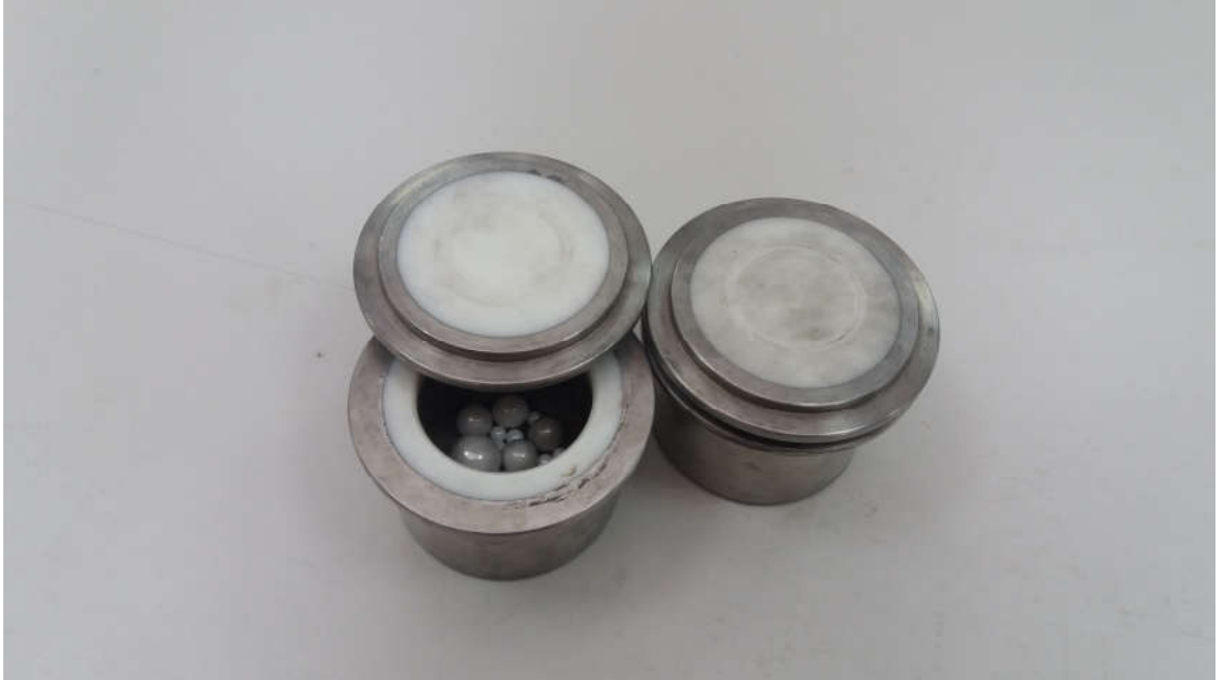
Şekil 4.1. Öğütme kapları ve bilyeleri
