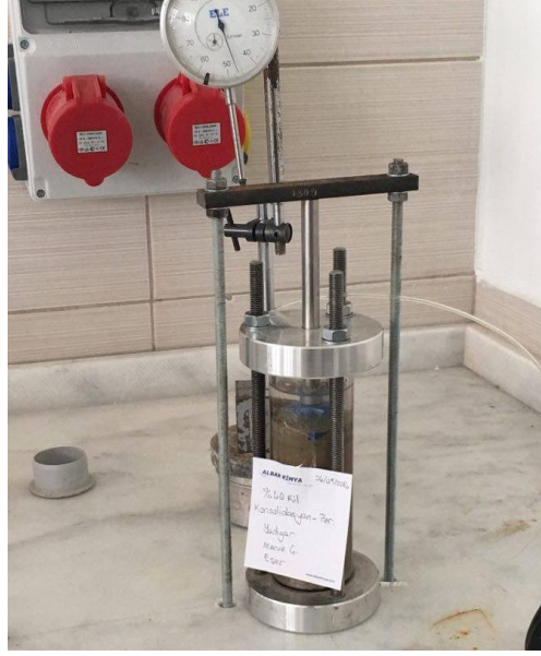
Şekil 5.16. Numunenin 1 kg ağırlığında 24 saat bekletilmesi
