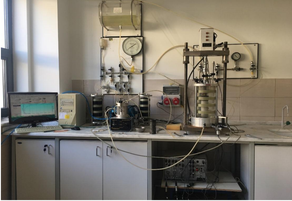
Şekil 4.1. Dinamik deneylerin yapıldığı CTX sistemi
