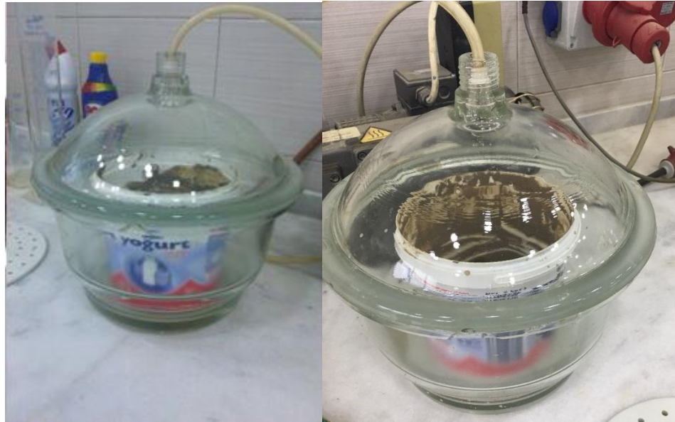
Şekil 5.14. Hazırlanan numuneye vakum uygulama
