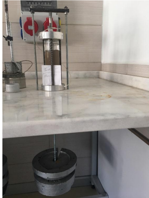
Şekil 5.17. Numunenin 100 kPa ağırlığında konsolide edilmesi
