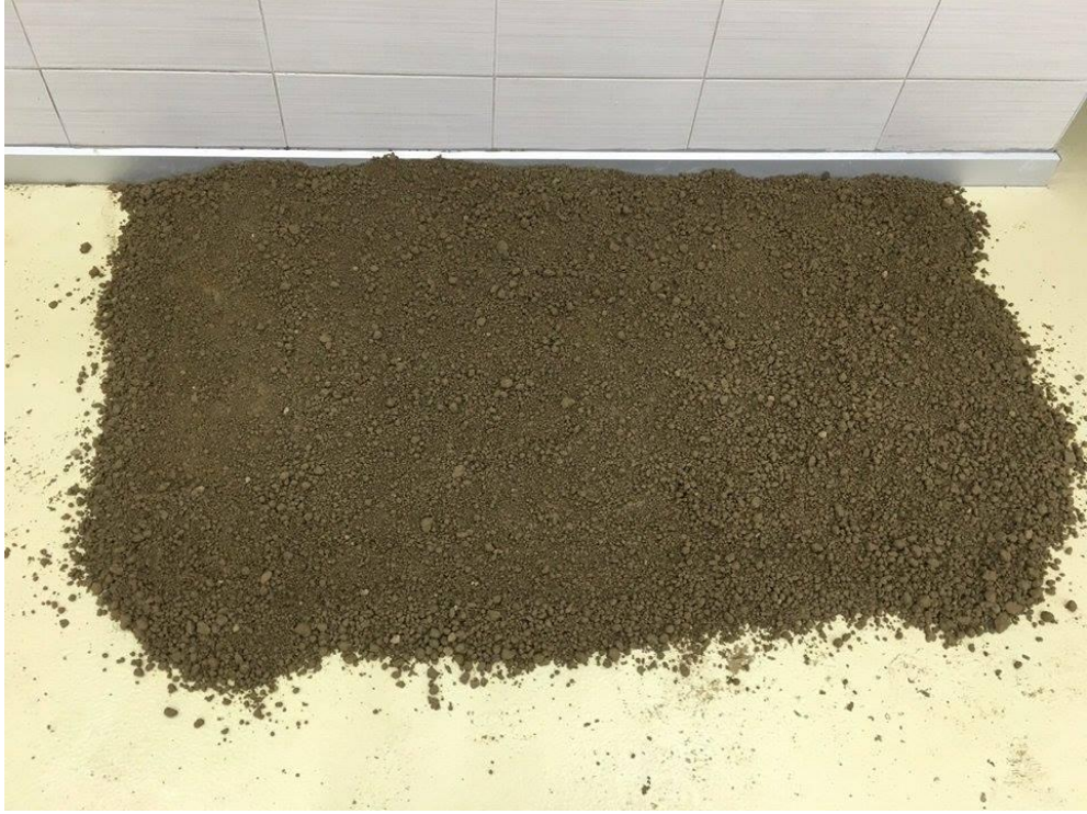
Şekil 5.3. 40 nolu elekten geçirilen silt numunenin kurutulması için serilme işlemi
