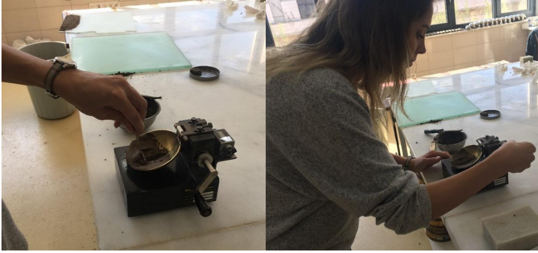
Şekil 5.7. Casagrande yöntemi ile likit limit deneyi
