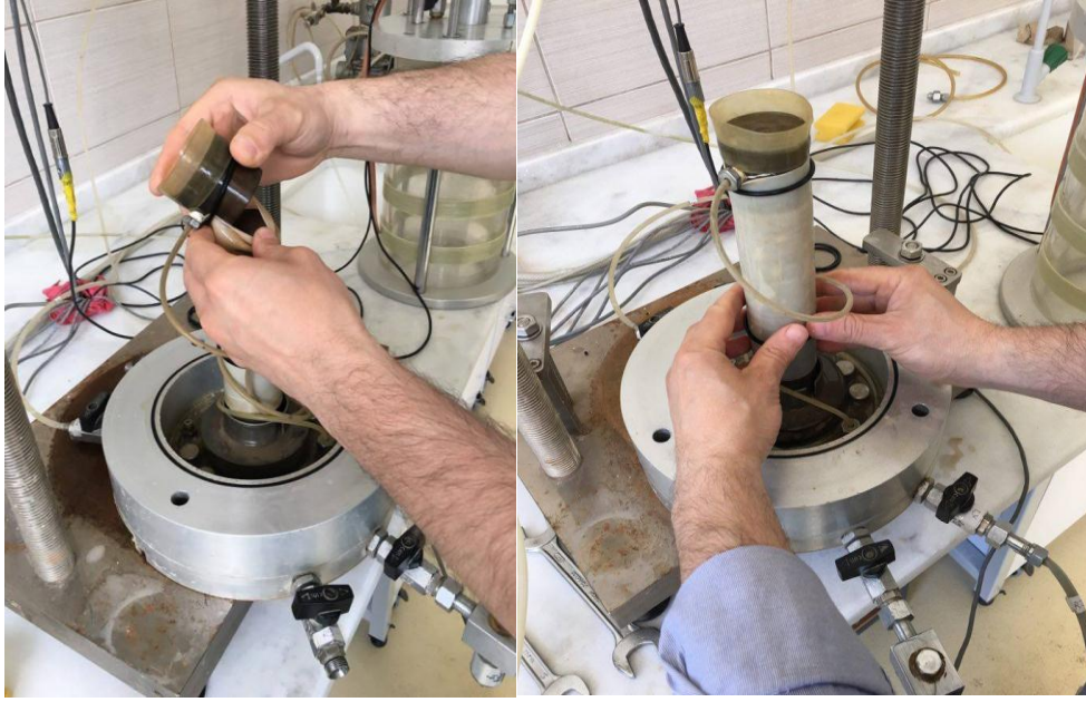
Şekil 5.20. CTX deney cihazına yerleştirilen deney numunesi
