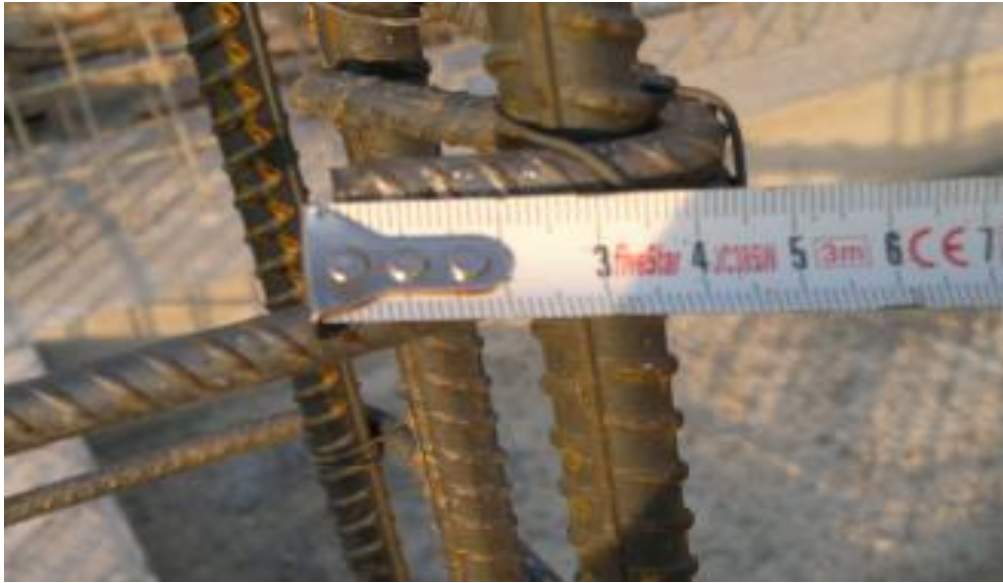
Şekil 5.10. Kanca boyu şartına uyulmaması
