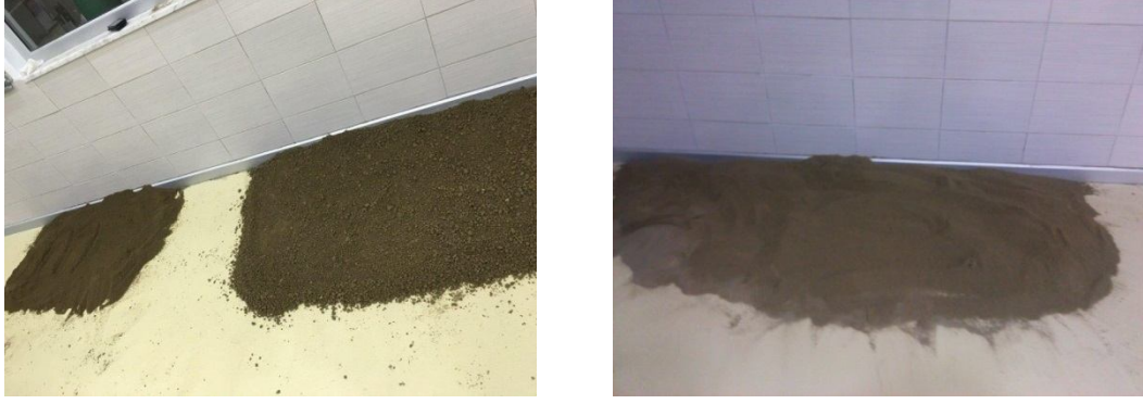
Şekil 5.3. Elekten geçirilen siltin serilip kurutulması
