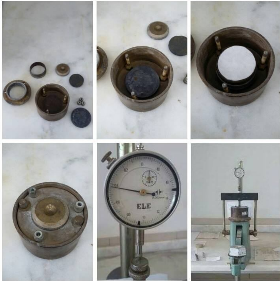
Şekil 5.19. Konsolidasyon hücresinin hazırlanması ve deneye başlanması
