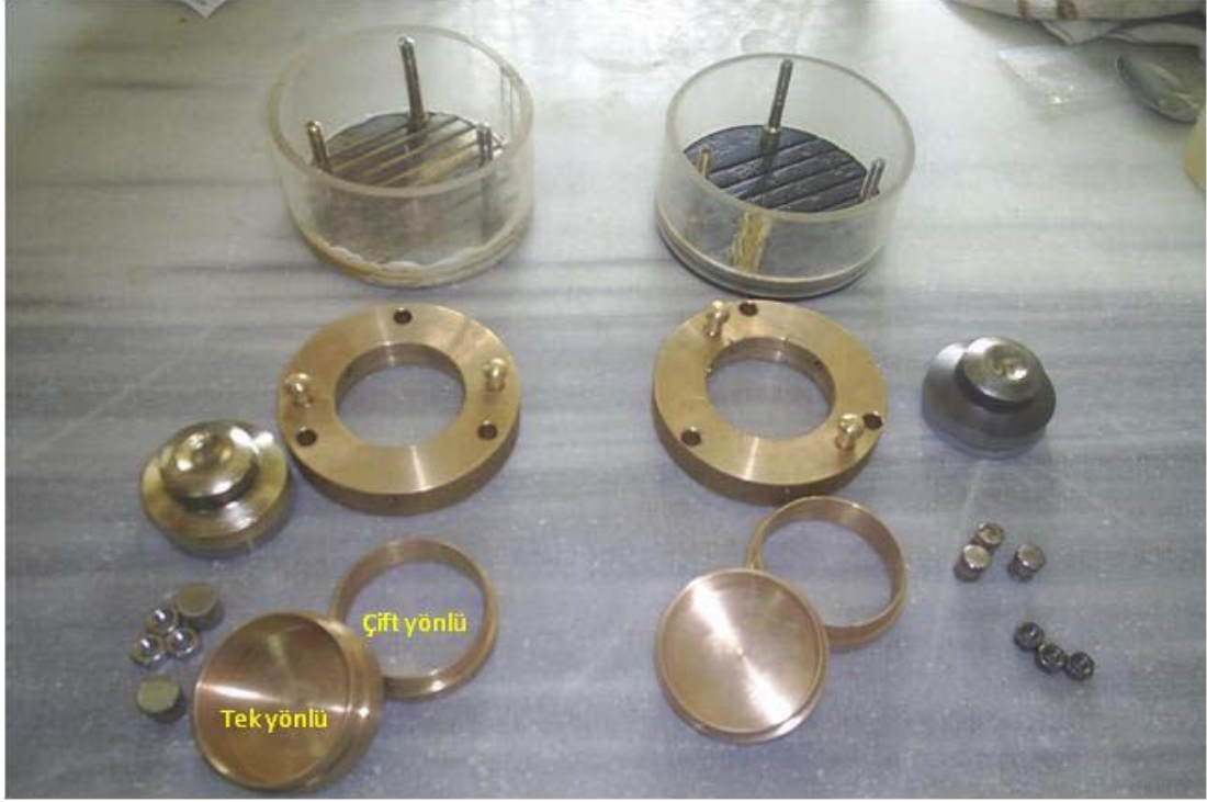
Şekil 4.2. Tek ve çift yönlü konsolidasyon hücresi [23]
