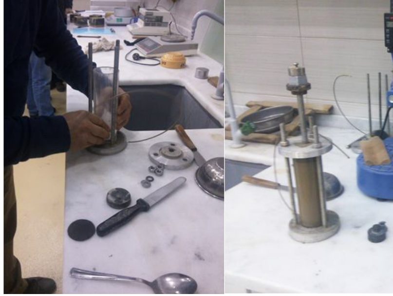
Şekil 5.14. Vakum uygulanan numunelerin 5 cm çaplı hücelere yerleştirilmesi
