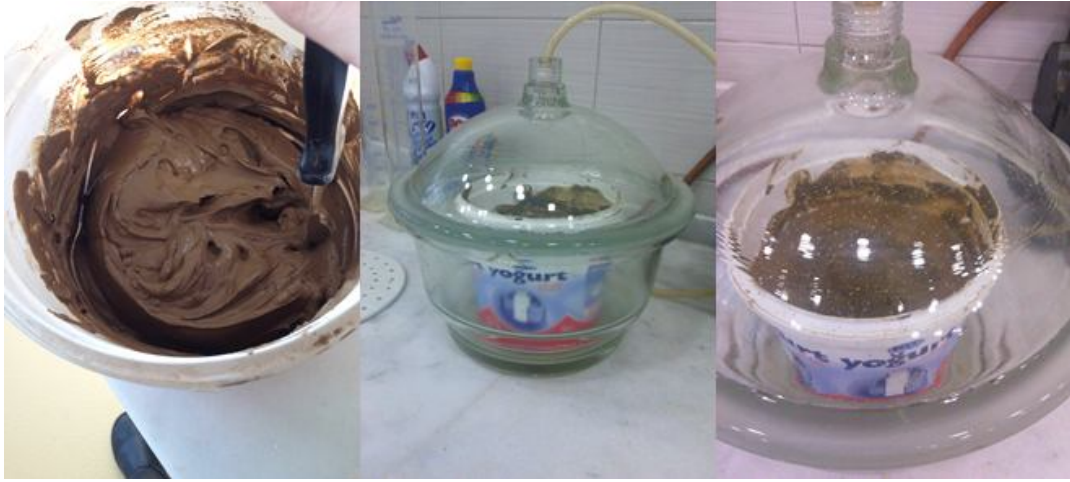
Şekil 5.13. Su ilave edilip hazırlanan numuneye vakum uygulama
