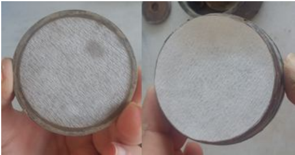
Şekil 5.18. Konsolidasyon hücresinin alt ve üst yüzeylerine filtre kağıdının yerleştirilmesi
