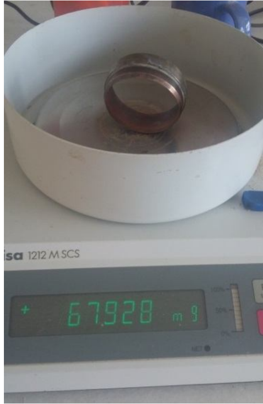
řekil 5.16. 50 mm apında ve 20 mm ykseklisinde konsolidasyon halkasının deney ncesi tartımı
