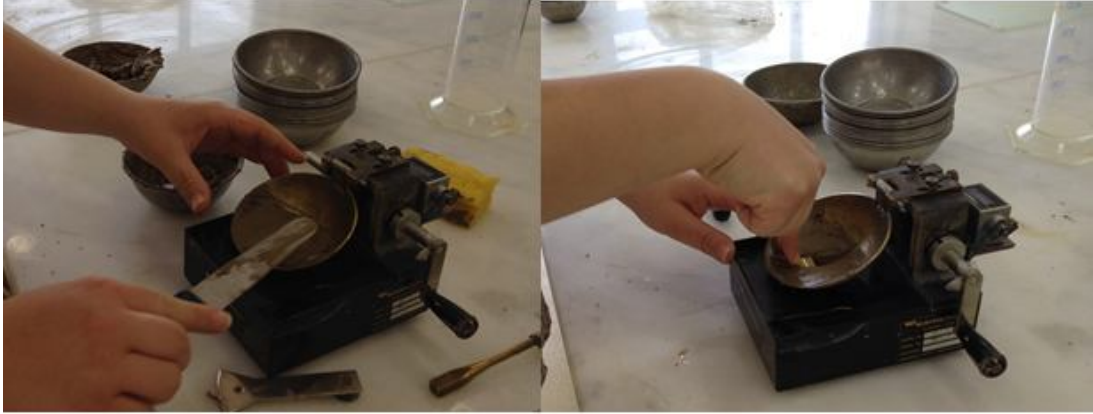
Şekil 5.6. Casagrande yöntemi ile likit limit deneyi
