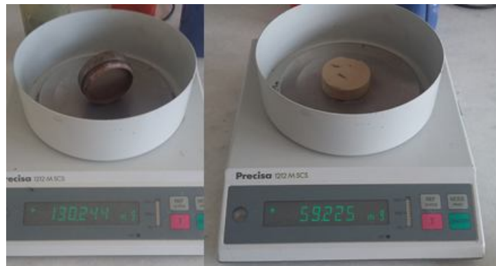
Şekil 5.23. Deney sonunda ve etüvden çıkarıldıktan sonra numunenin tartımı
