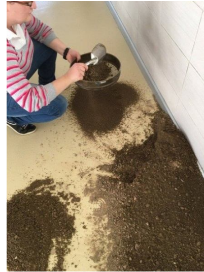
Şekil 5.2. Numunenin 40 nolu elekten elenmesi
