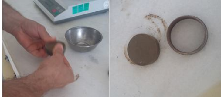
Şekil 5.22. Numunenin konsolidasyon halkasından çıkarılması
