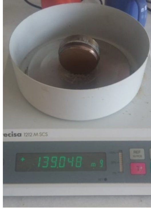
Şekil 5.17. Konsolidasyon halkası ile beraber hazırlanan numunenin deney öncesi tartımı
