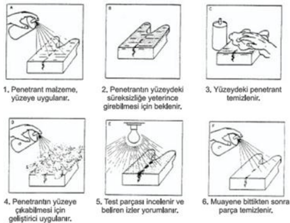
Şekil 7.10. Yüzey çatlak kontrol adımları
