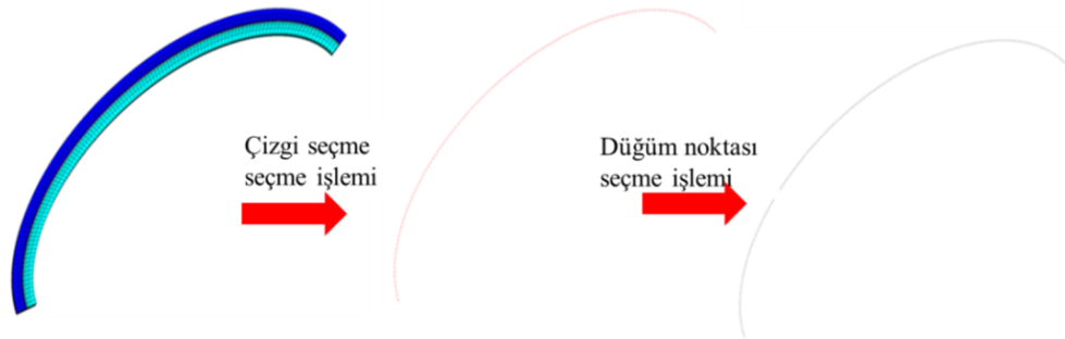
Şekil 3.21. Çatlak ucu düğüm noktalarının seçimi.
