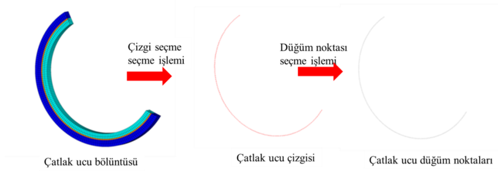
Şekil 3.11. Çatlak ucu düğüm noktalarının seçimi.
