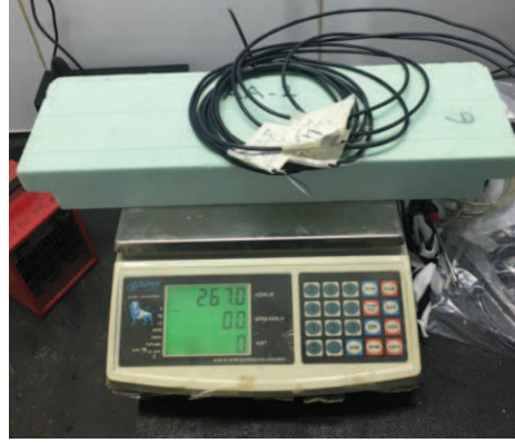
Şekil 4.2. Gravimetrik yöntem ile nem miktarı ölçümü
