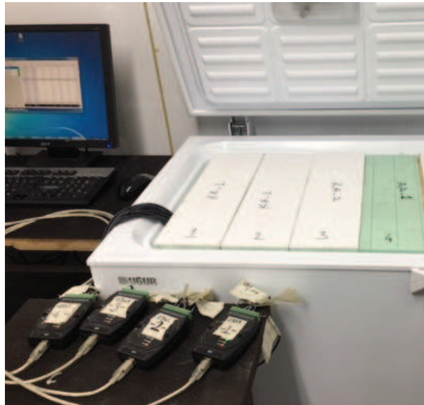
Şekil 4.8. Termal çiftler, veri toplama sistemi ve bilgisayar bağlantısı
