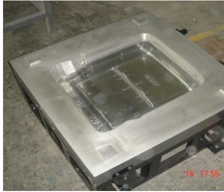
Şekil 3.3. Sünger üretiminde kullanılan alüminyum plastik kalıbı [54].
