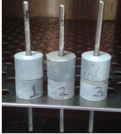
Şekil 6.28. Yapışma mukavemeti deneyinde kullanılan granit görünümlü polimer kaplanmış 25,4 mm çapındaki silindirik numuneler.
