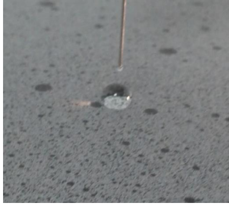
Şekil 7.25. Granit görünümlü kaplamanın kontak açısı ölçümü sırasındaki suyun yüzey üzerinde oluşturduğu küresel formun görüntüsü.
