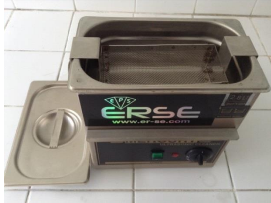
Şekil 6.6. Alüminyum altlık malzemelerin temizlenmesinde kullanılan ultrasonik temizleme cihazı.
