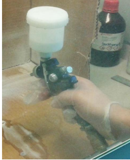
Şekil 6.11. Nano SiO 2 toz katkıli ikinci bileşime sahip polimer esaslı kaplamanın püskürtülmesine ait görüntü.
