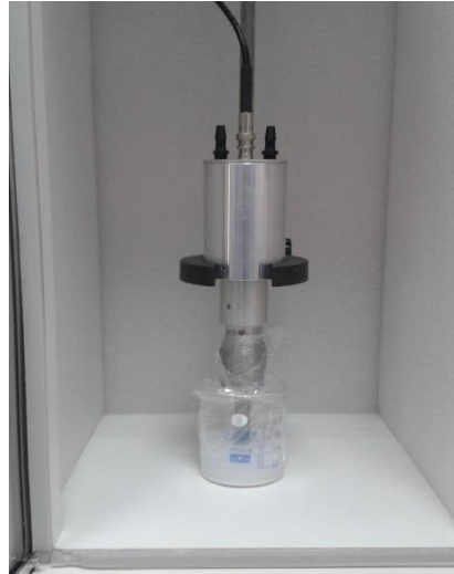
Şekil 6.10. Nano SiO_2 toz katkılı ikinci bileşime sahip polimer esaslı kaplamanın ultrasonik karıştırıcıdaki görüntüsü.
