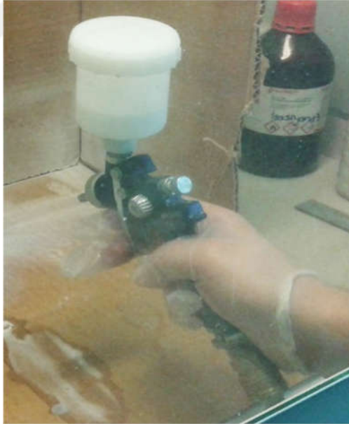
Şekil 5.8. Nano TiO 2 katkılı 2. bileşime sahip polimer esaslı kaplamanın spreylendirilmesine ait görüntü
