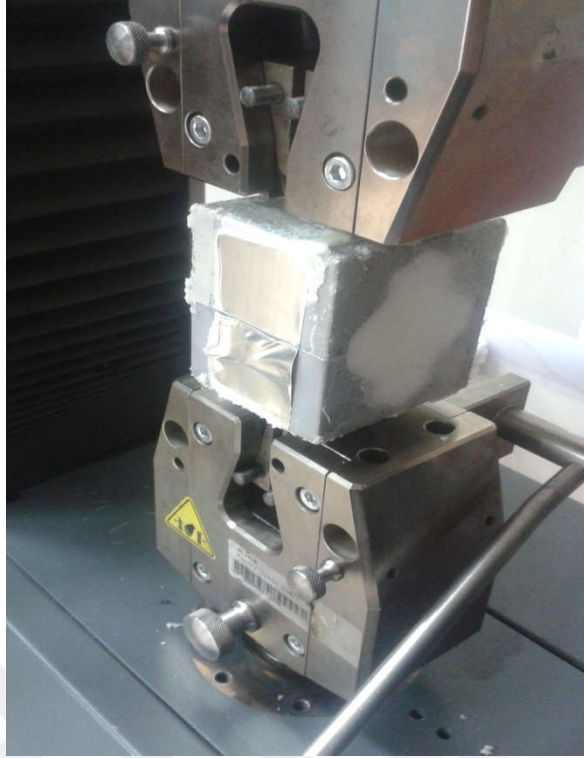
Şekil 6.38. PU dökümü yapılmış kalıbın çekme deney düzeneğindeki görünümü
