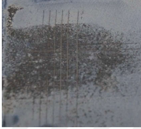
Şekil 6.30. Kumlanmış eloksallanmış altlığa uygulanan %3,5 TiO 2 ve %10 PTFE katkıli 3 numaralı kaplama için yapılan cross-cut deney sonucu
