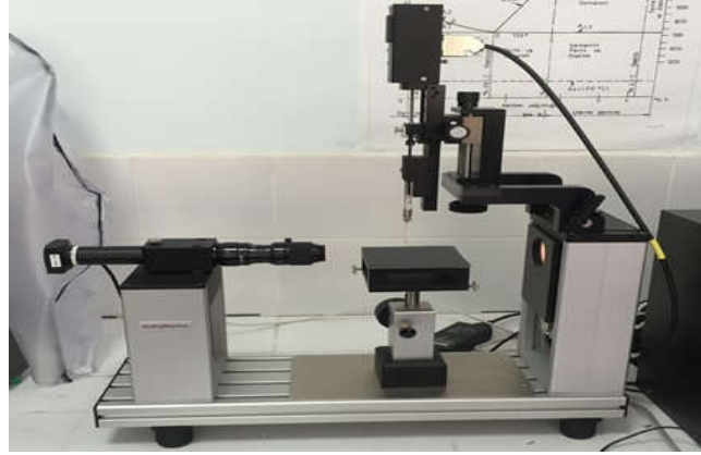
Şekil 5.17. Kullanım temas açısı ölçüm cihazı
