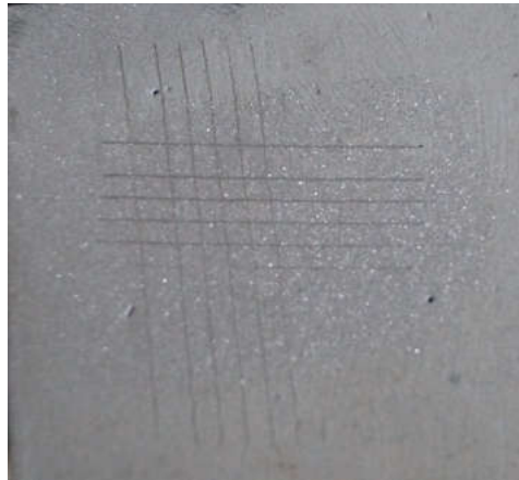
Şekil 6.29. Kumlanmış altlığa uygulanan %3,5 TiO 2 ve %10 PTFE katkıli 3 numaralı kaplama için yapılan cross-cut deney sonucu
