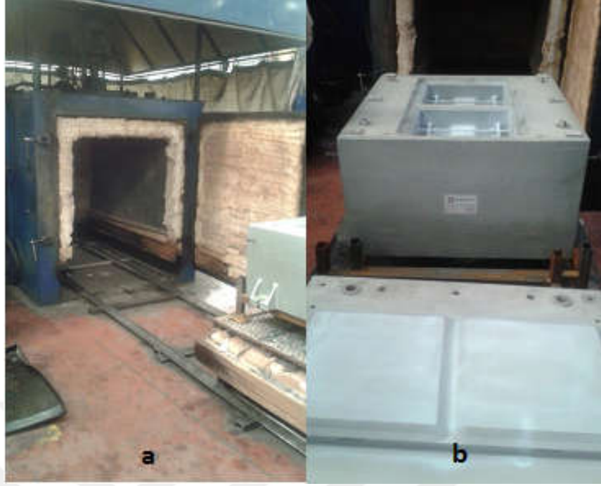
Şekil 6.43. Kalıbın küreleme işlemi görüntüleri, a) fırın, b) kalıp
