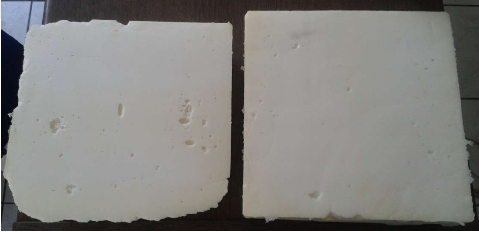
Şekil 6.45. Prototip kalıptaki üst kapağın süngerle temas ettiği kısmın görüntüsü
