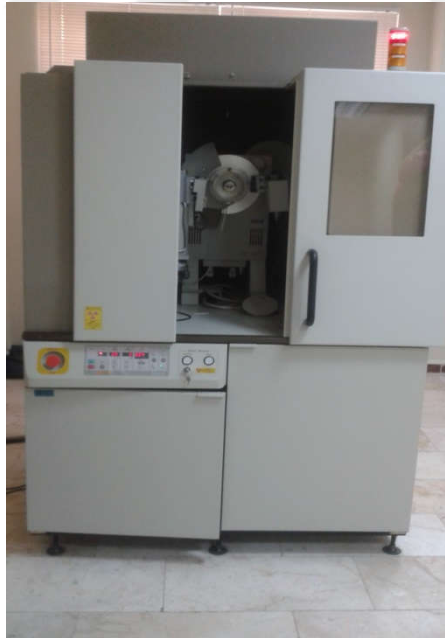
Şekil 5.13. Analiz yönteminde kullanılan Rigaku Dimaks 2200 marka X-ışınları difraktometresi
