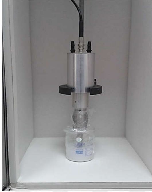
Şekil 5.7. Nano TiO 2 katkılı 2. bileşime sahip polimer esaslı kaplamanın ultrasonik karıştırıcıda karıştırılması ait görüntü
