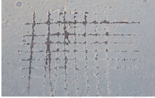
Şekil 6.28. Kumlanmış eloksallanmış altlığa uygulanan %3,5 TiO 2 ve %10 PTFE katkıli 2 numaralı kaplama için yapılan cross-cut deney sonucu
