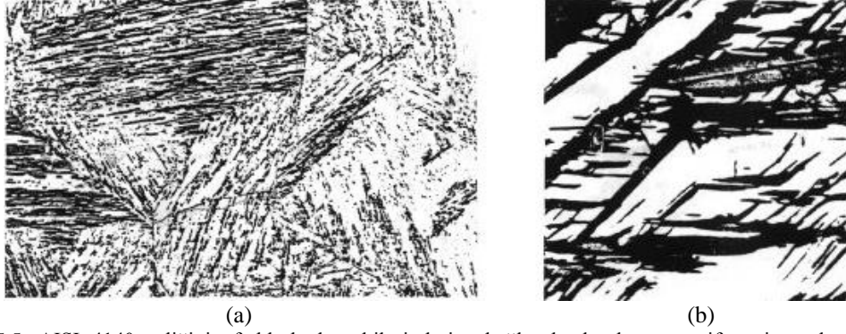
Şekil 5.5. AISI 4140 çeliğinin farklı karbon bileşimlerine bağlı olarak oluşan masif ve ignesel martenzit mikroyapıları. Düşük alaşımlı (% 0,35 C ve % 2 Mn) karbon çeliğinde masif martenzit yapısı (a), Yüksek karbonlu (% 1,2 C) çelikte ignesel martenzit yapısı (b) [52].
