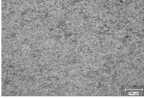
Şekil 5.9. Sertleştirilmiş ve 350°C’de iki saat temperlenmiş AISI 4140 çeliğinin mikroyapısı [58].
