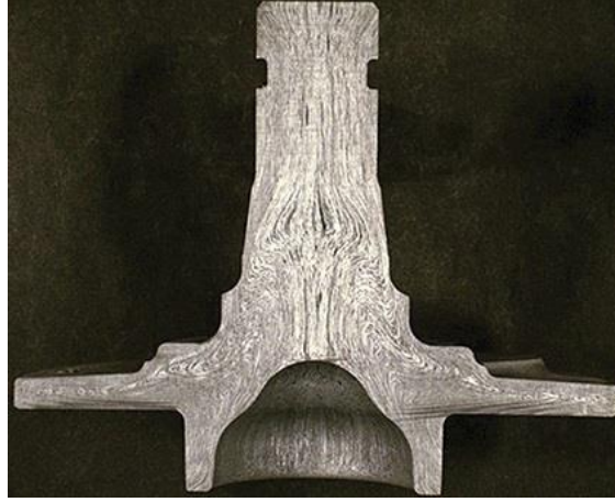
Şekil 4.1. Dövme sonrası oluşmuş lif yapısı [46].
