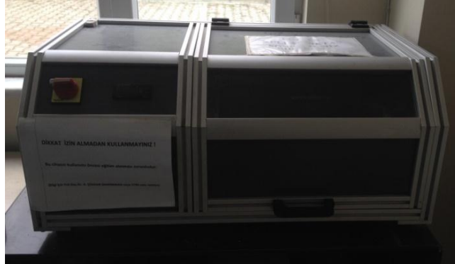
Şekil 5.2. Tozların karıştırılmasında kullanılan MSE marka tek eksenli karıştırıcı.
