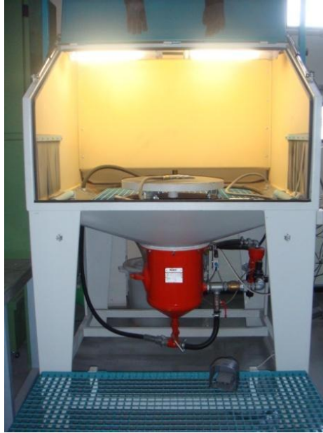
Şekil 5.11. Altlık malzemesinin kumlanmasında kullanılan SAPI marka basınçlı kumlama makinası.
