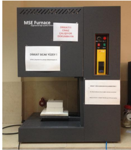
Şekil 5.5. Sinterleme işleminin yapıldığı MSE marka kamara tipi sinterleme fırını.
