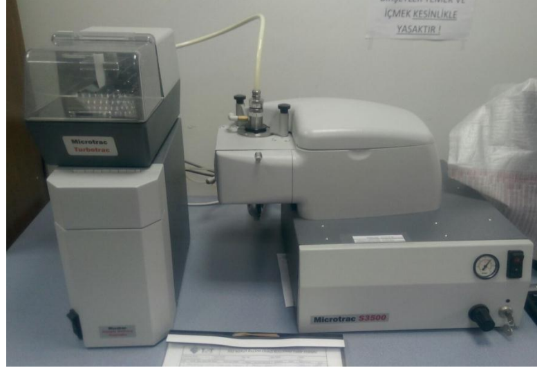
Şekil 5.9. Toz boyut analizi cihazı MICROTRAC S3500.
