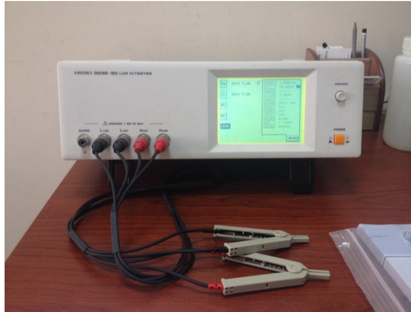
Şekil 5.10. Dielektrik sabiti ölçüm cihazı HIOKI 3532-50 LCR HiTESTER
