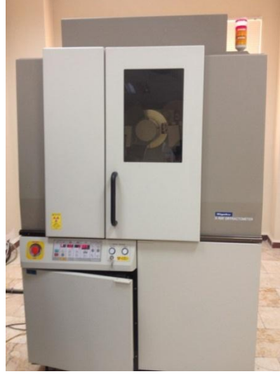
Şekil 5.18. RIGAKU marka X-Ray difraktometre cihazı.
