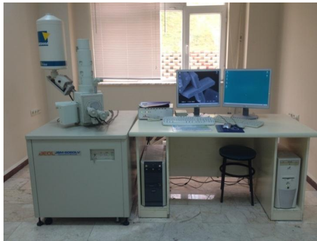
Şekil 5.19. JEOL JSM6060LV marka SEM cihazı.
