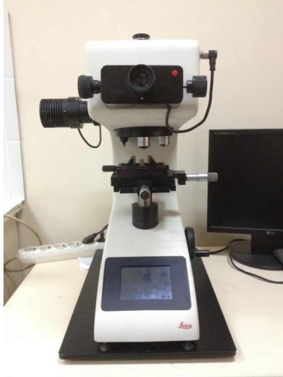
Şekil 5.17. LEICA VM HTMOT marka mikrosertlik ölçüm cihazı.
