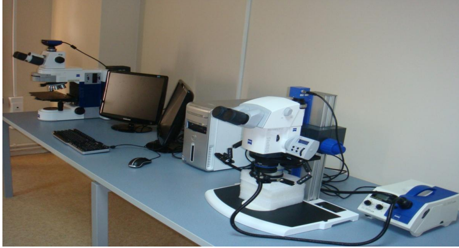
Şekil 5. 16. Optik ve yüzey incelemelerinin yapıldığı ZEISS marka optik ve stereo mikroskop.
