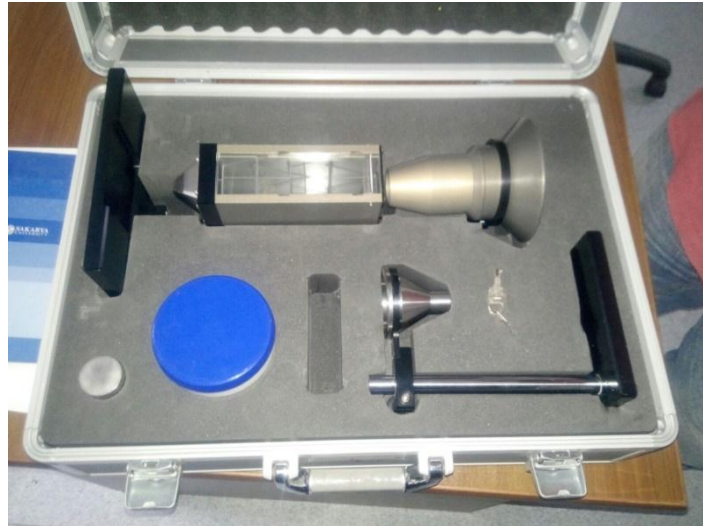
Şekil 5.8. Toz akış hızı ölçüm cihazı HALL Flowmeter HF100.
