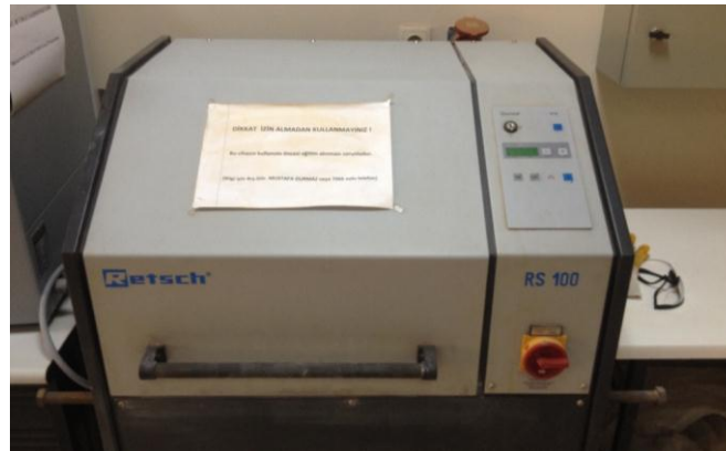
Şekil 5.6. RETSCH marka halkalı değirmen.
