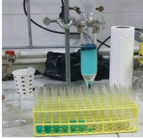
Şekil 2.7. Kolon kromatografi düzeneği
