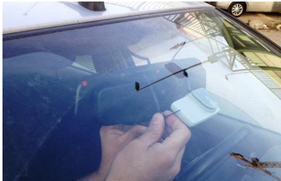
Şekil 2.2. İç dikiz aynasının önüne montaj
