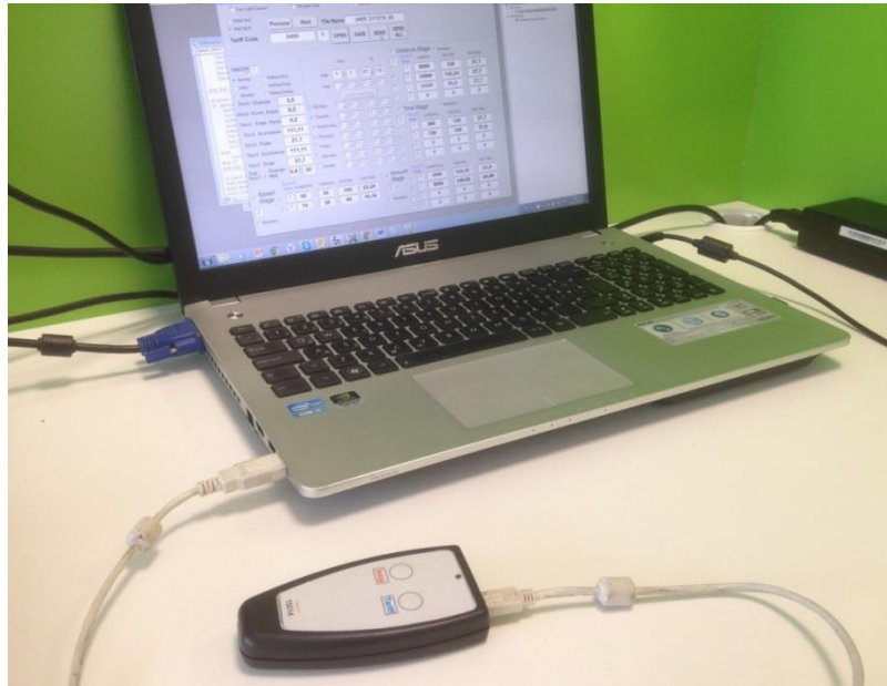
Şekil 4.27. Tarife yükleme cihazının bilgisayara bağlanması
