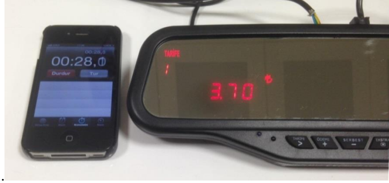
Şekil 4.35. Taksimetre zaman ölçüm testi
