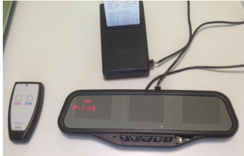
Şekil 4.31. Taksimetredeki tarife parametrelerinin yazıcıdan basılması
