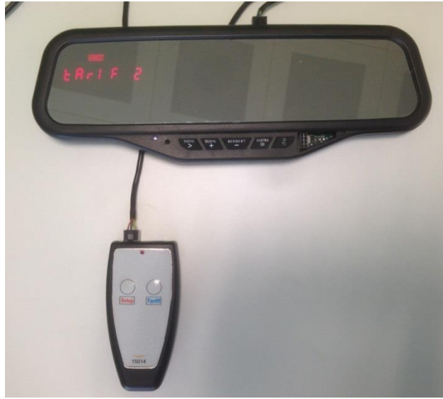
Şekil 4.28. Tarife yükleme cihazının taksimetreye bağlanması
