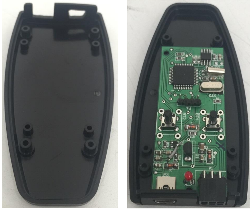
Şekil 4.4. Tarife yükleme cihazı PCB montaj
