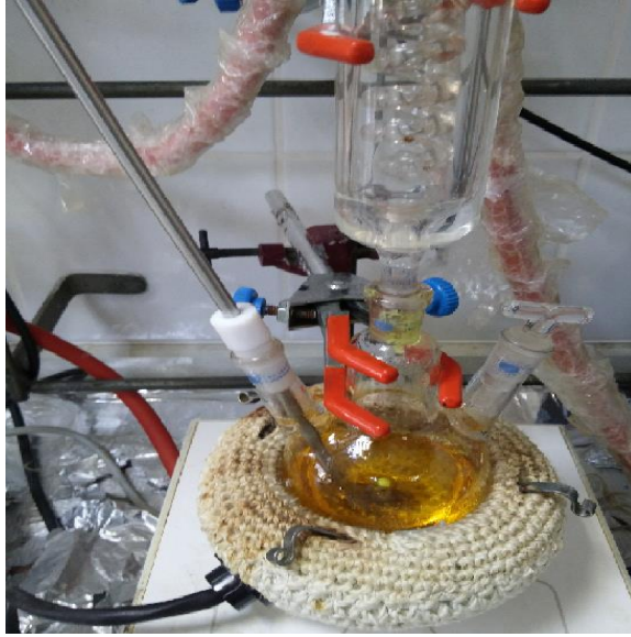
Şekil 3.6. 2-metil-1 H -pirol(63) sentezi reflüks düzeneği
