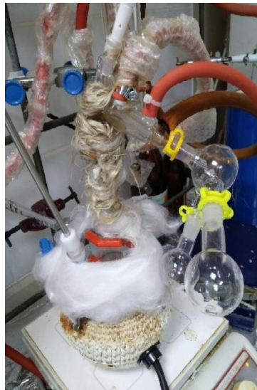
Şekil 3.7. 2-metil-1 H -pirol(63) sentezi destilat düzeneği
