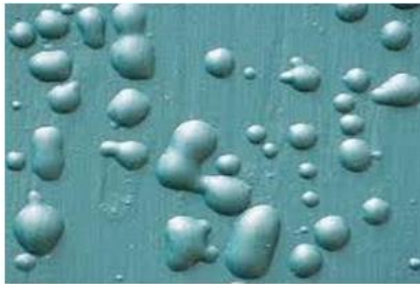
Şekil 5.6. Boyalı alüminyum yüzeydeki blister oluşumu
