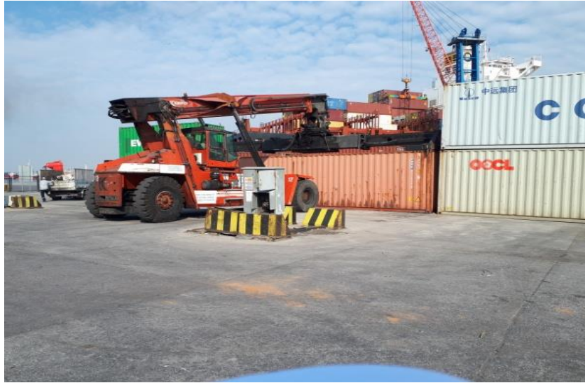
Şekil 6.11. Konteyner'in taşıyıcı vinç ile yarından alınması
