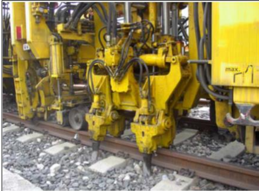
Şekil 6.1. Buraj makinesi çalışırken [39]
