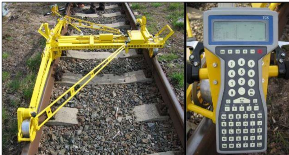
Şekil 7.7. Hat geometrisi ölçüm cihazı ve el bilgisayarı [50]
