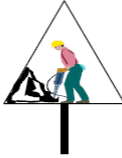
Şekil 6.8. Çalışan takıma dikkat levhası
