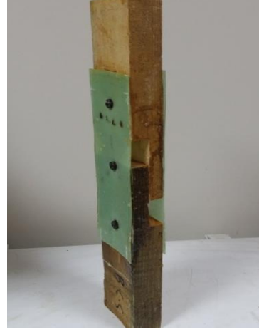
Şekil 6.14. Deney sonrası GFRP levhalı kertmeli birleştirme numunesi
