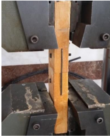
Şekil 6.41. Çekme makinesine bağlanmış metal levhali yabancı zıvanalı birleştirme numunesi
