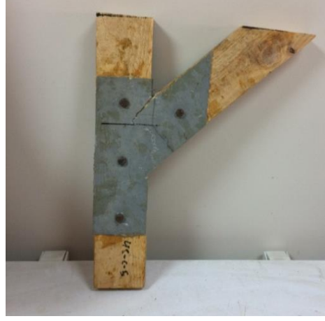
Şekil 6.104. Deney sonrası GFRP levhalı 45° birleştirme numunesi
