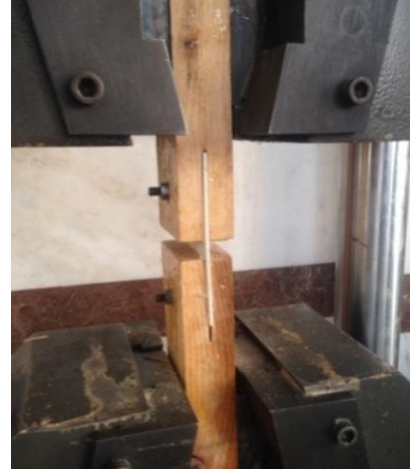
Şekil 6.50. Deney sonrası GFRP levhalı yabancı zıvanalı birleştirme numunesi
