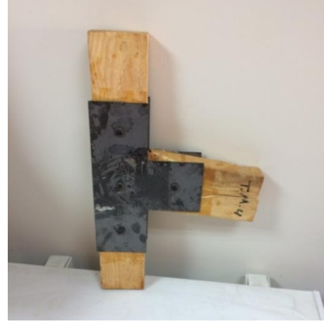
Şekil 6.78. Deney sonrasım metal levhalı T birleřtirme numunesi
