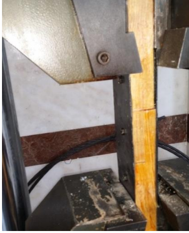
Şekil 6.4. Çekme makinesine bağlanmış metal levhalı kertmeli birleştirme numunesi
