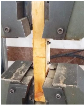
Şekil 6.19. Çekme makinesine bağlanmış ham uç uca boy birleştirme numunesi
