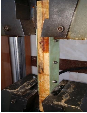
Şekil 6.13. Çekme makinesine bağlanmış GFRP levhalı kertmeli birleştirme numunesi
