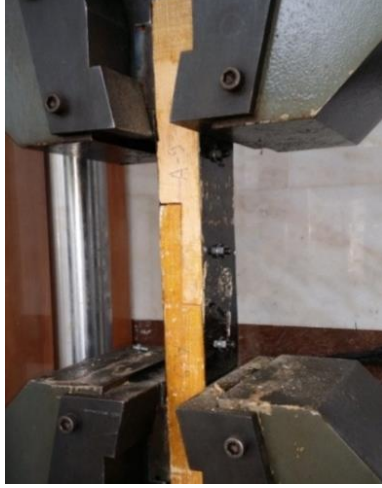
Şekil 6.9. Çekme makinesine bağlanmış CFRP kertmeli boy birleştirme numunesi
