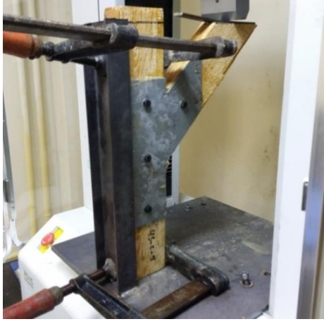
Şekil 6.103. Çekme-eğilme makinesine bağlanmış GFRP levhalı 45° birleştirme numunesi
