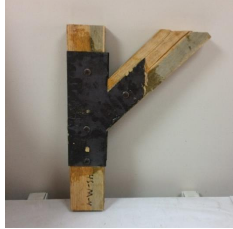
Şekil 6.96. Deney sonrası metal levhalı 45° birleştirme numunesi
