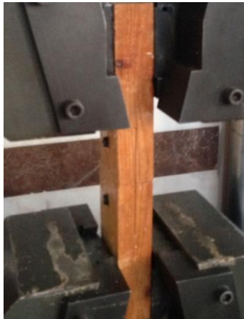
Şekil 6.37. Çekme makinesine bağlanmış ham yabancı zıvanalı birleştirme numunesi
