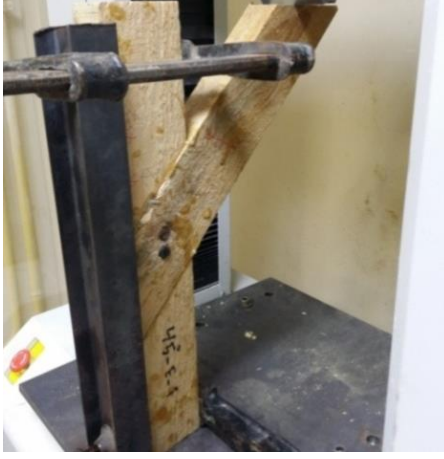
Şekil 6.91. Çekme-eğilme makinesine bağlanmış ham 45° gönye birleştirme numunesi
