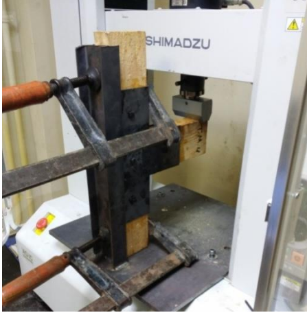
Şekil 6.77. Çekme eğilme makinesine baėlanmıř metal levhalı T birleřtirme numunesi
