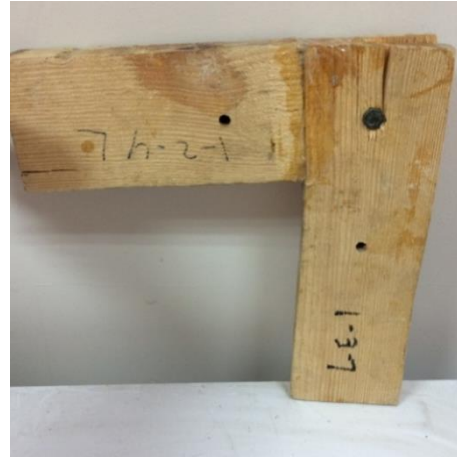
Şekil 6.56. Deney sonrası ham L tipi birleřtirme numunesi
