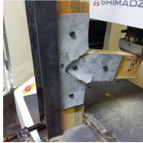
Şekil 6.86. Deney sonrası GFRP levhalı T birleřtirme numunesi
