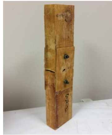
Şekil 6.20. Deney sonrası ham uç uca boy birleştirme numunesi
