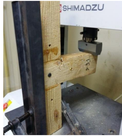
Őekil 6.74. Deney sonrası ham T tipi birleřtirme numunesi
