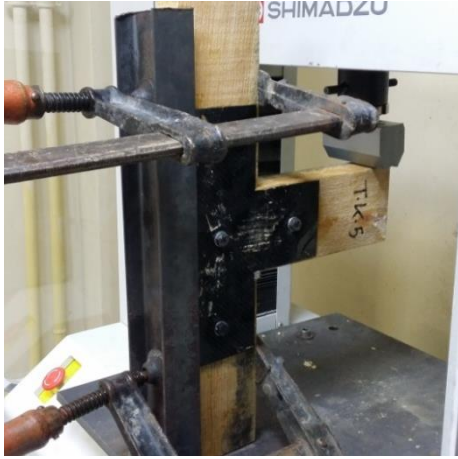
Şekil 6.81. Çekme-eğilme makinesine bağlanmış CFRP levhalı T birleřtirme numunesi
