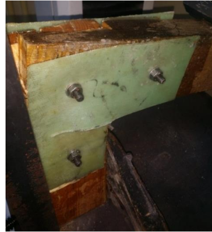
Şekil 6.68. Deney sonrası GFRP levhalı L birleřtirme numunesi
