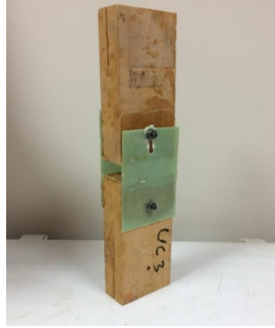
Şekil 6.32. Deney sonrası GFRP levhali uç uca birleştirme numunesi
