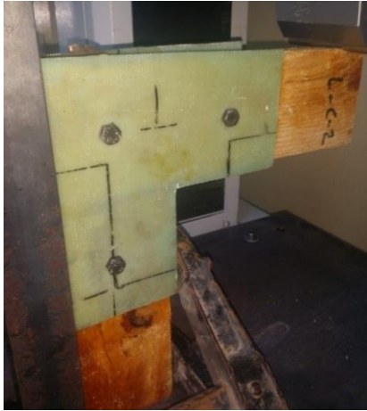
Şekil 6.67. Çekme-eğilme makinesine baėlanmıř GFRP levhalı L birleřtirme numunesi
