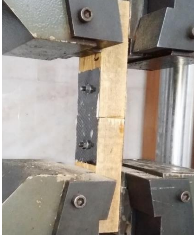
Şekil 6.27. Çekme makinesine bağlanmış CFRP levhalı uç uca birleştirme numunesi
