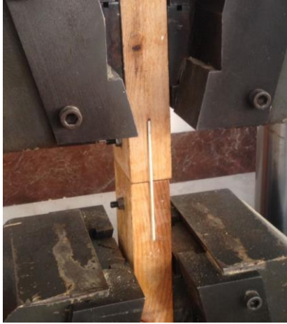
Şekil 6.49 Çekme makinesine bağlanmış GFRP levhalı yabancı zıvanalı birleştirme numunesi
