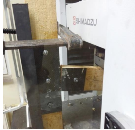
Şekil 6.82. Deney sonrası CFRP levhalı T birleřtirme numunesi
