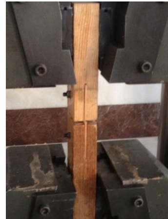
Şekil 6.38. Deney sonrası ham yabancı zıvanalı birleştirme numunesi
