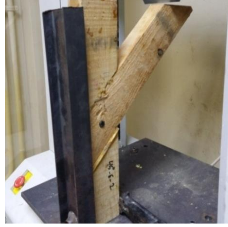
Şekil 6.92. Deney sonrası ham 45° gönye birleştirme numunesi
