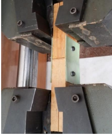
Şekil 6.31. Çekme makinesine bağlanmış GFRP levhali uç uca birleştirme numunesi
