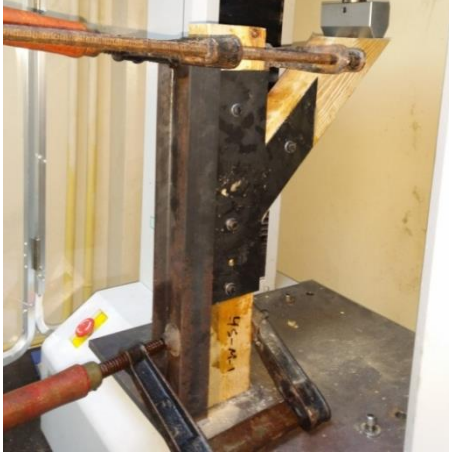
Şekil 6.95. Çekme-eğilme makinesine bağlanmış metal levhalı 45° birleştirme numunesi
