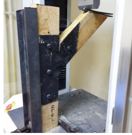
Şekil 6.100. Deney sonrası CFRP levhalı45° birleştirme numunesi
