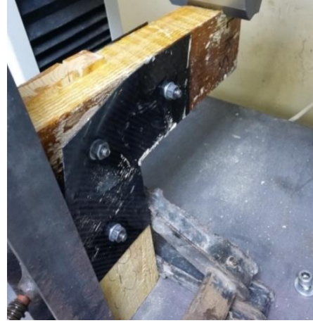
Şekil 6.64. Deney sonrası CFRP levhalı L birleştirme numunesi
