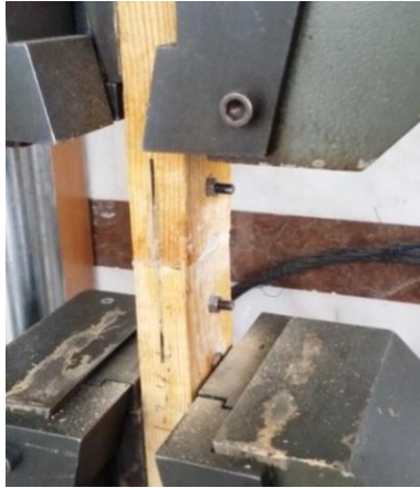
Şekil 6.45. Çekme makinesine bağlanmış CFRP levhalı yabancı zıvanalı birleştirme numunesi
