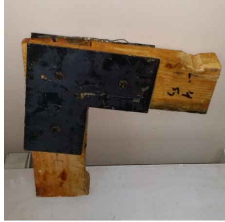
Şekil 6.60. Deney sonrası metal levhalı L birleřtirme numunesi
