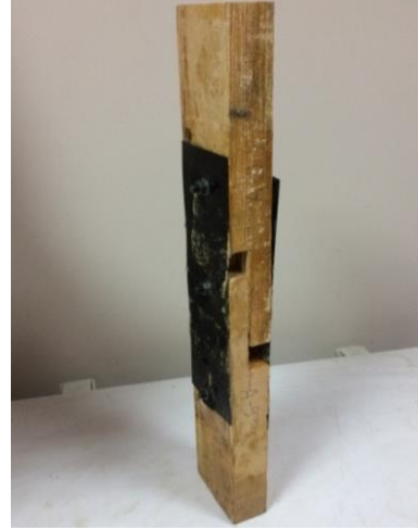
Şekil 6.10. Deney sonrası CFRP kertmeli boy birleştirme numunesi
