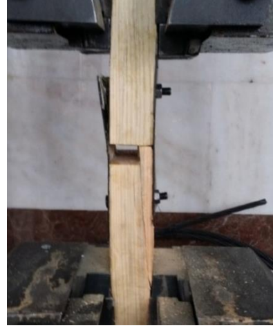
Şekil 6.28. Deney sonrası CFRP levhalı uç uca birleştirme numunesi
