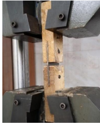
Şekil 6.42. Deney sonrası metal levhali yabancı zıvanalı birleştirme numunesi
