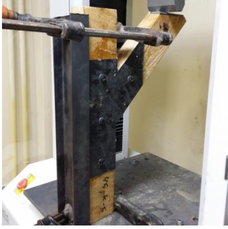
Şekil 6.99. Çekme-eğilme makinesine bağlanmış CFRP levhalı45° birleştirme numunesi
