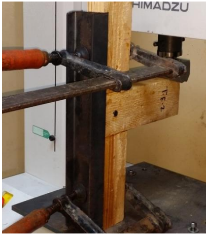
Őekil 6.73. Çekme eęilme makinesine baęlanmış ham T tipi birleřtirme numunesi
