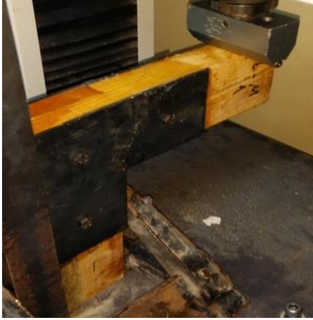
Şekil 6.59. Çekme eğilme makinesine bağlanmış metal levhalı L birleřtirme numunesi
