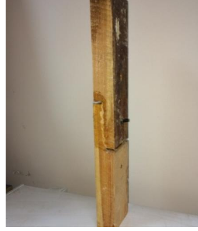
Şekil 6.1. Deney sonrası ham kertmeli boy birleştirme numuneleri
