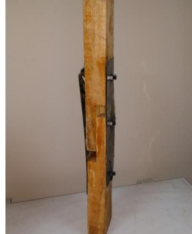
Şekil 6.5. Deney sonrası metal levhalı kertmeli birleştirme numunesi
