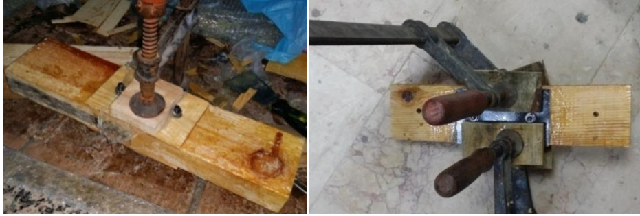
Şekil 4.6. İşkenceler kullanarak boy birleştirme numuneleri preslenmesi
