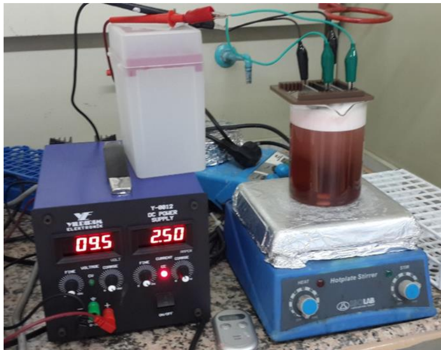
Şekil 3.1. Elektrokoksidasyon deney düzeneği.
