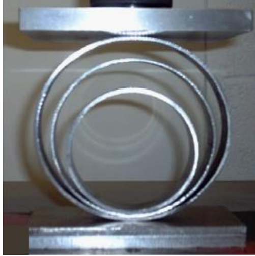
Şekil 2.4. İç içe geçmiş üç tüplü sistem [13].
