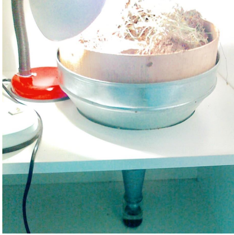
Şekil 2.3. Berlese hunilerinden oluşan ayıklama düzeneği
