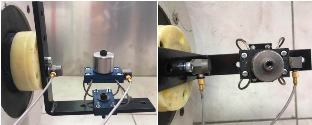
Şekil 3.17. 7x7, 1x19 ve 7x19 ÇHTİ yatay yöndeki titreşim testleri
