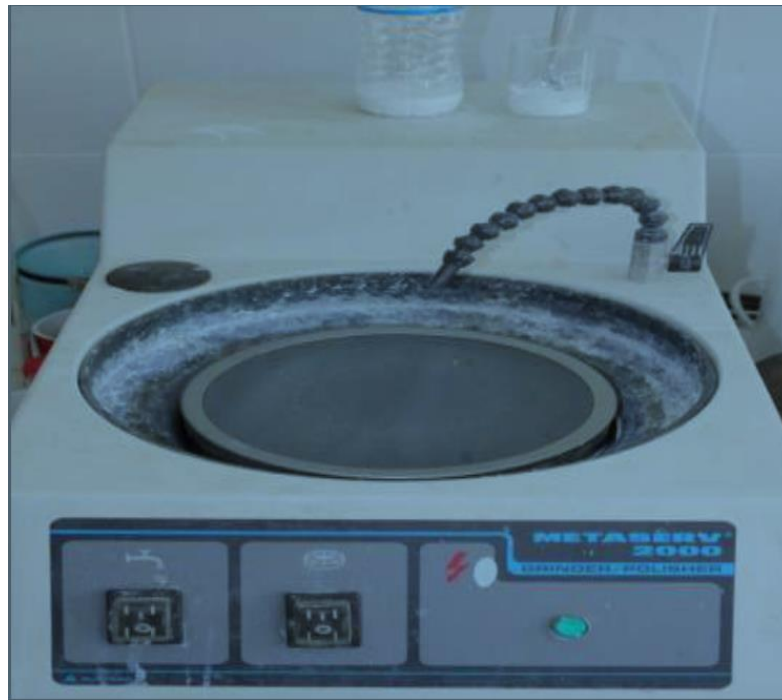
Şekil 3.2. Metalografik incelemede kullanılan zımparalama cihazı
