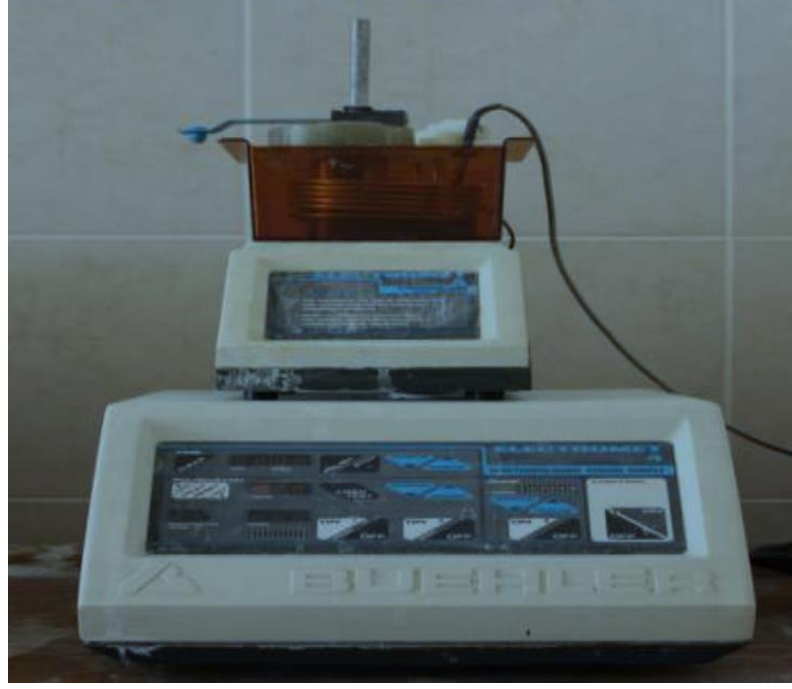
Şekil 3.3. Metalografik incelemede kullanılan elektrolitik parlatma ve dađlama cihazı
