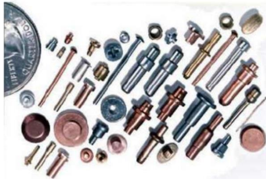
Şekil 2.1. Mikro şekillendirme ile üretilmiş çeşitli metal komponentlerin bir fotoğrafı [3]
