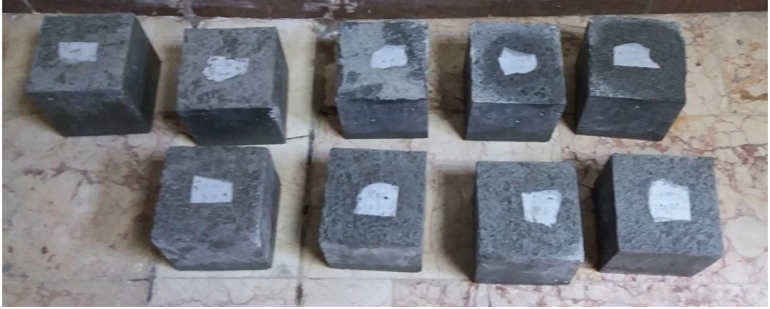
Şekil 4.7. Basınç deneyi için hazırlanan küp numuneler
