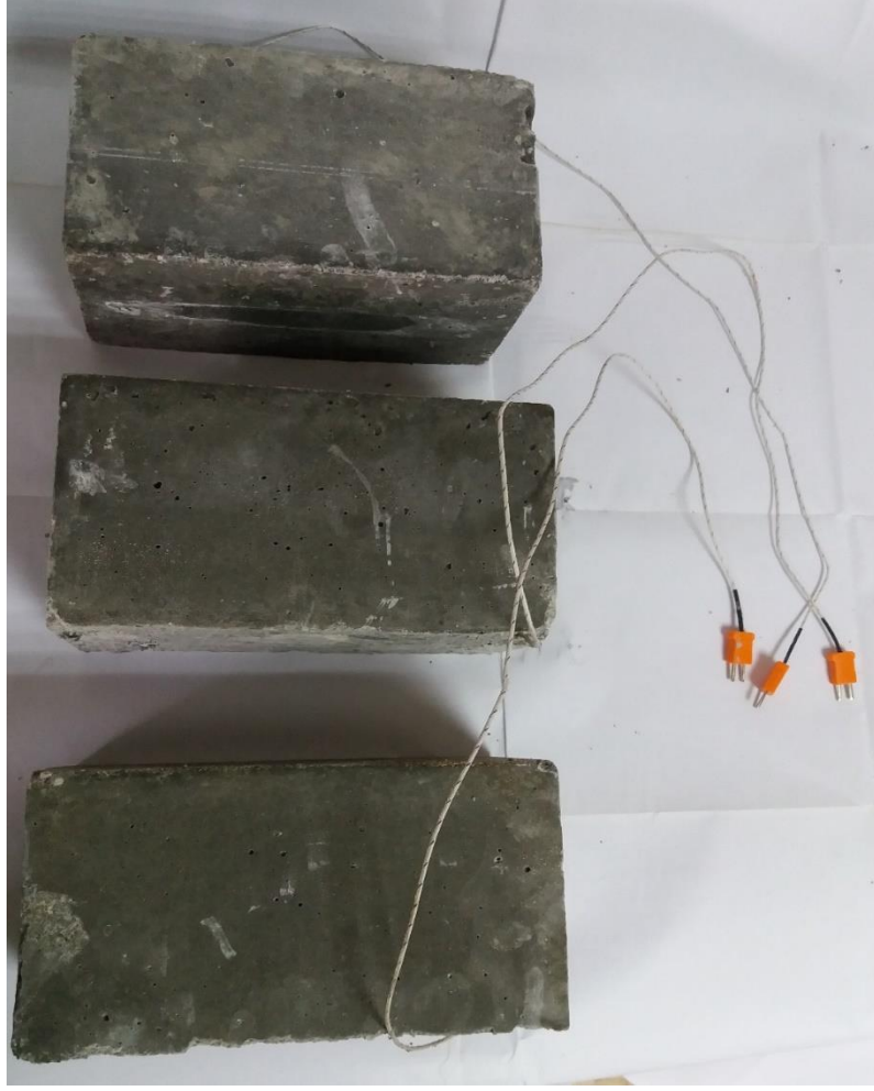
Şekil 4.17. C20, C30, C40 6 cm paspayına sahip numunelerimiz
