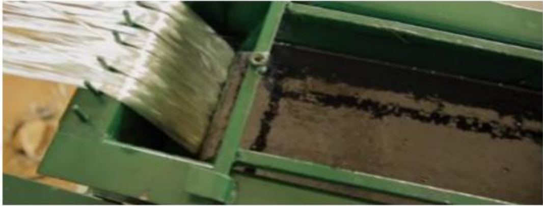
Şekil 2.7. FRP donatı çubuklarının reçine ile birleşimi [19]
