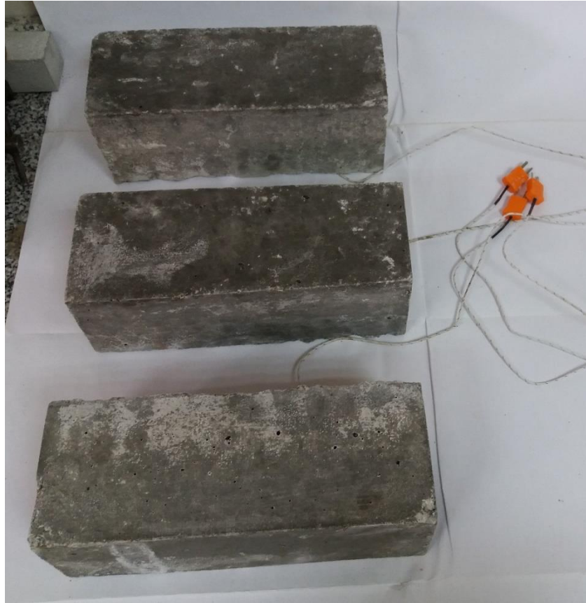
Şekil 4.16. C20, C30, C40 4 cm paspayına sahip numunelerimiz
