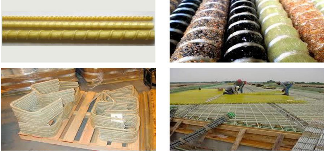
Şekil 2.11. Yapılarda FRP bar kullanım şekilleri [28]
