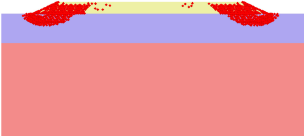
Şekil 5.18. 5 m yumuşak kil tabakasında dolgunun tamamının tek seferde yüklenmesinden oluşan göçme durumunda plastik noktalar
