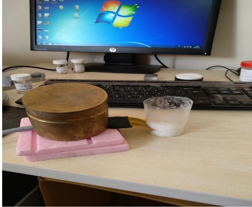
Şekil 4.22. C-THERM / TCi Thermal Conductivity markalı cihaz ile örnek ölçüm.
