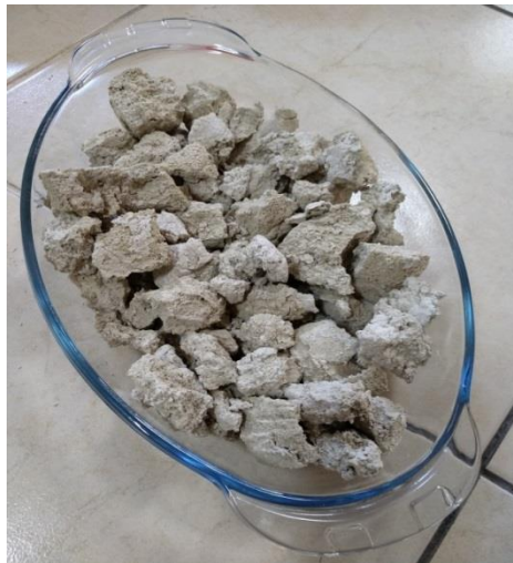
Şekil 4.3. Boraks şlamı atığının (etüvde kurutulmuş) makro görüntüsü.
