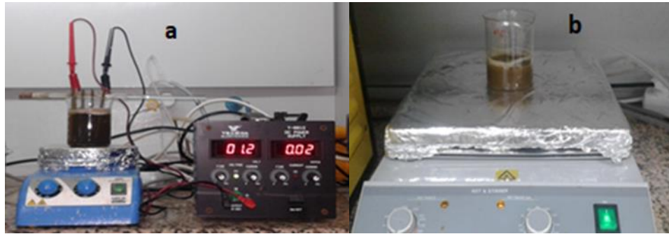
Şekil 3.1. a. Peroksi-elektrokoagülasyon b. fenton deney düzeneği.
