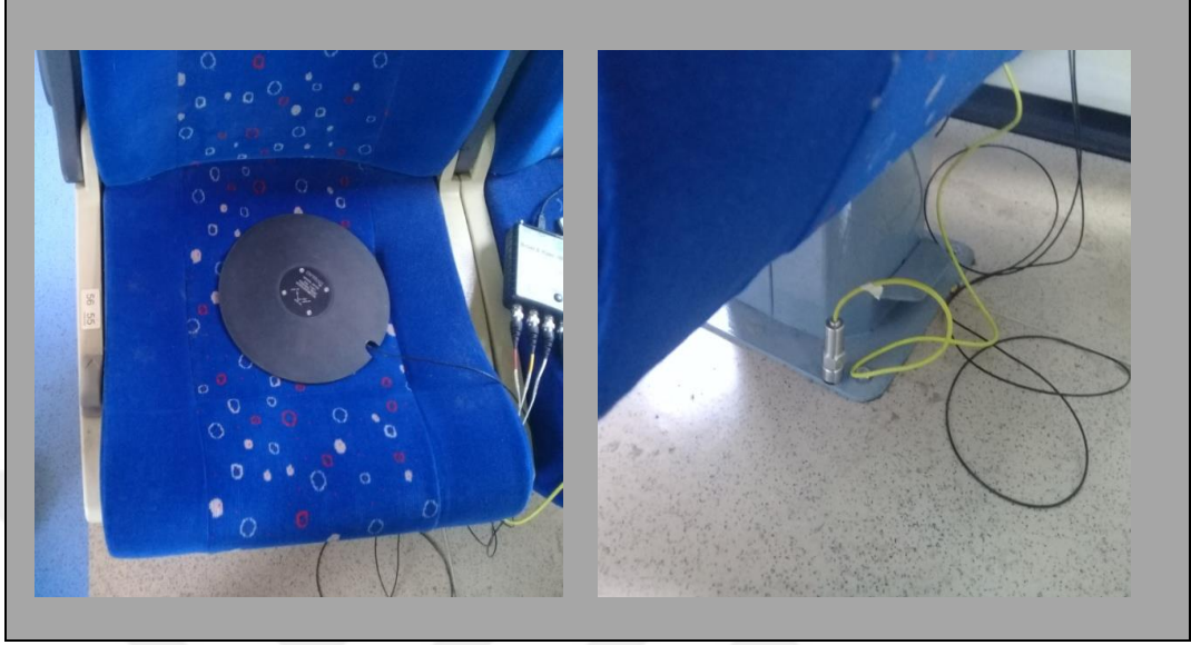
Şekil 5.3. Koltuk ve zemine yerleştirilen titreşim ölçüm cihazları
