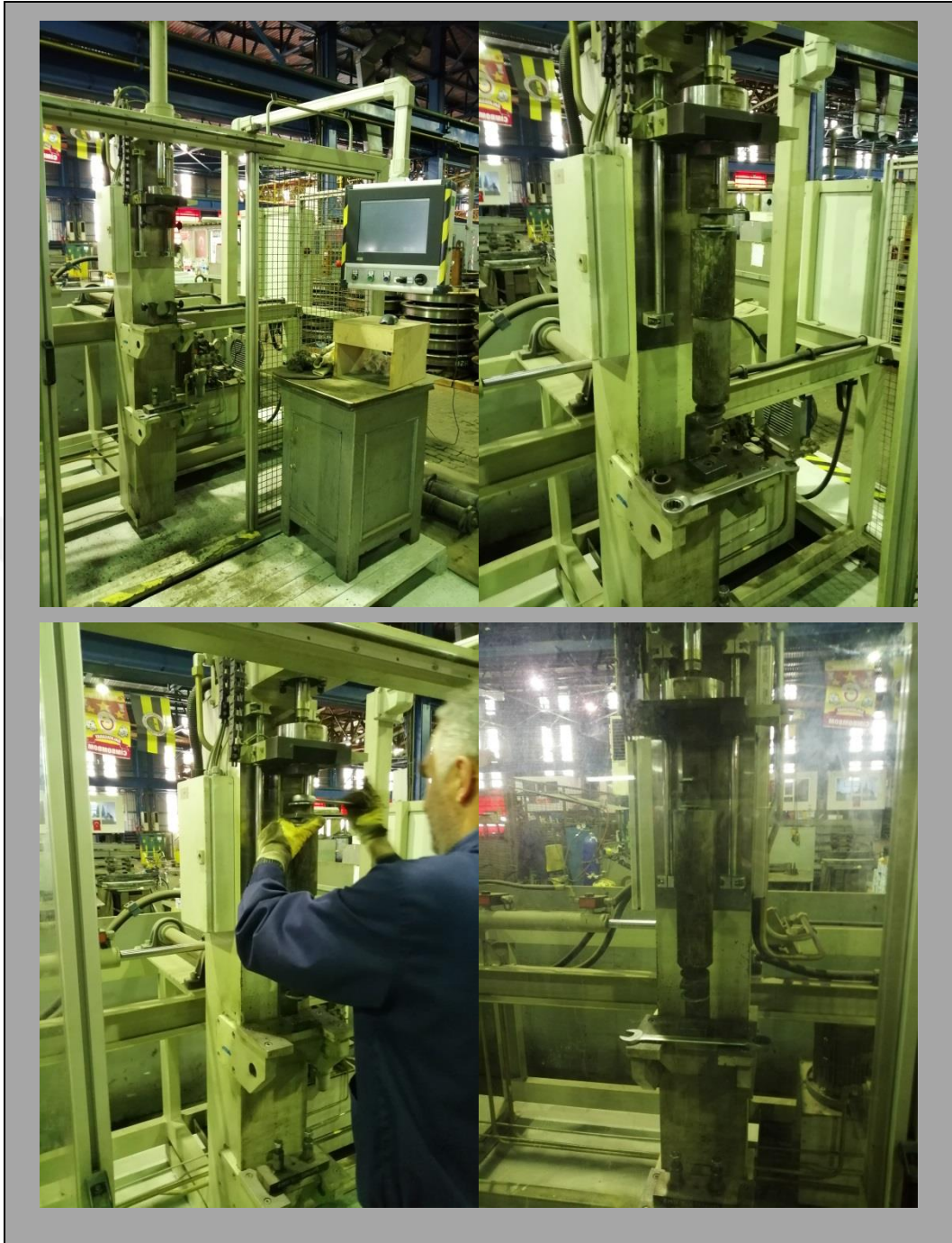
Şekil 3.27. Y32 boji birinci süspansiyon dikey amortisör test işlemi
