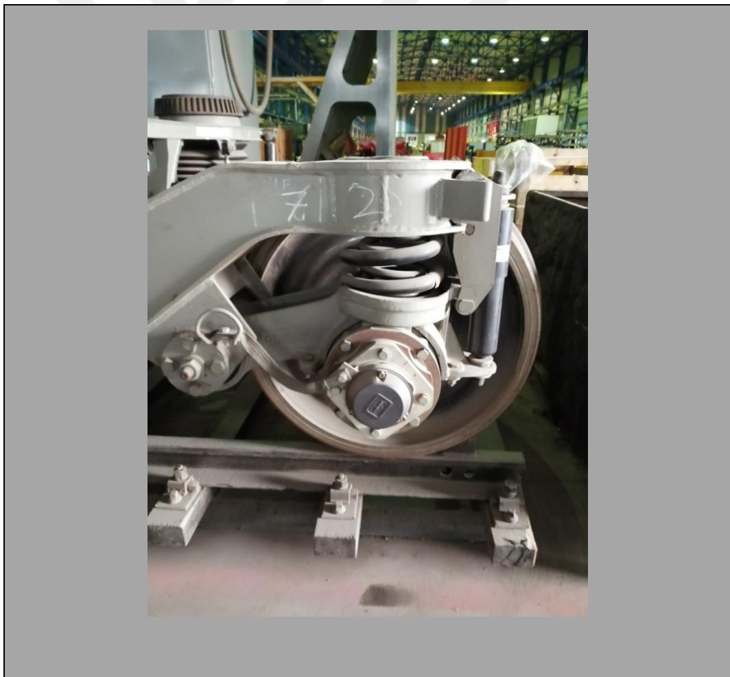
Şekil 3.10. Y32 birinci süspansiyon sistemi yerleşim
