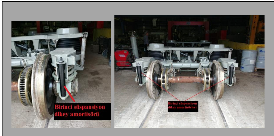
Şekil 3.16. Y32 boji birinci süspansiyon sistemi dikey amortisör yerleşimi
