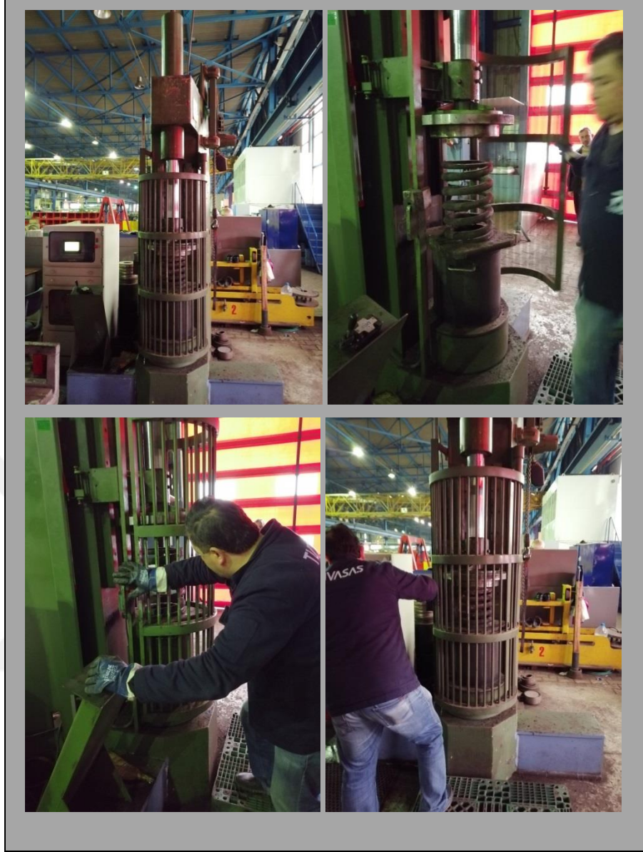
Şekil 3.25. Y32 boji birinci süspansiyon sistemi helisel yayının test işlemi
