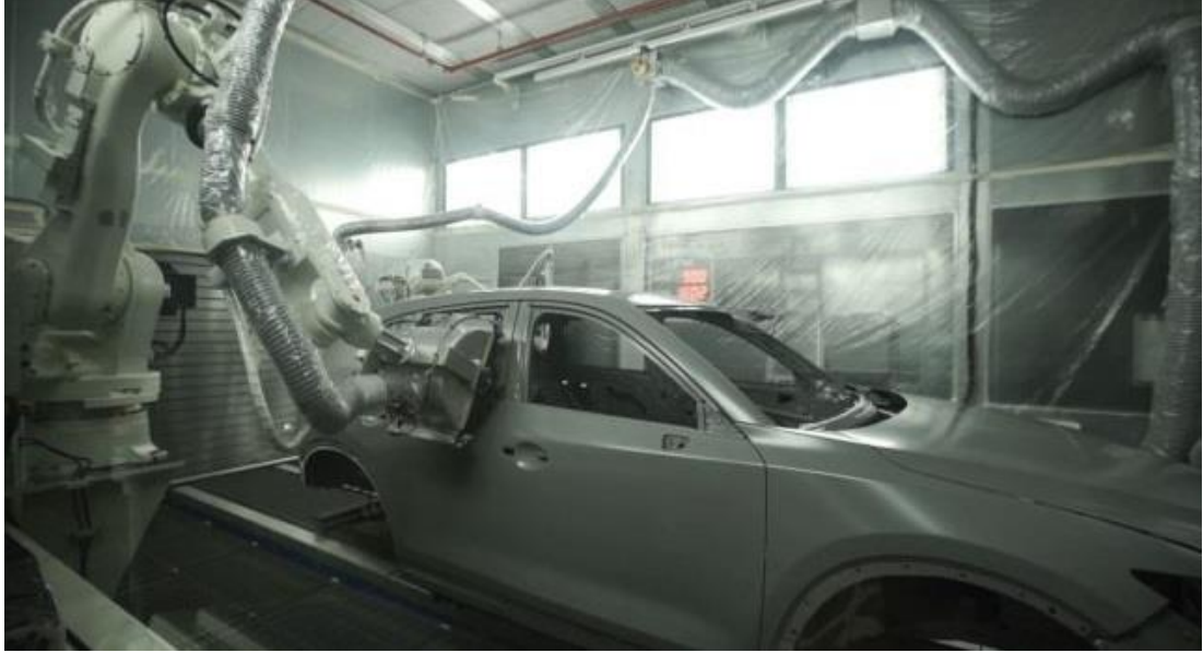
Şekil 2.4. Sprey boyama gerçekleştirilen robot kabini [10].
