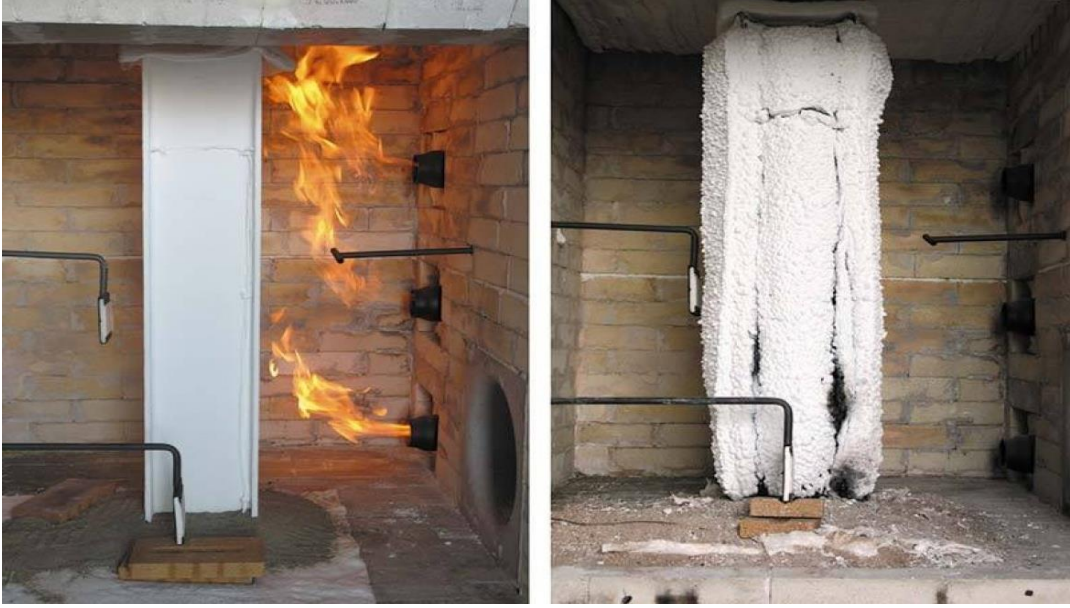
Şekil 4.18. Yangına dayanıklı boya deney sonucu [52].
