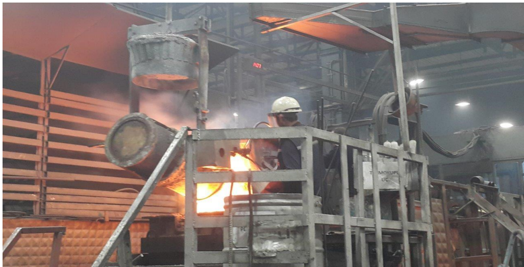
Resim 5.3. Mg tretman işlemi bitimi sonrası sıvı metalin tandış haznesine aktarımı ve aşılama işlemi.
