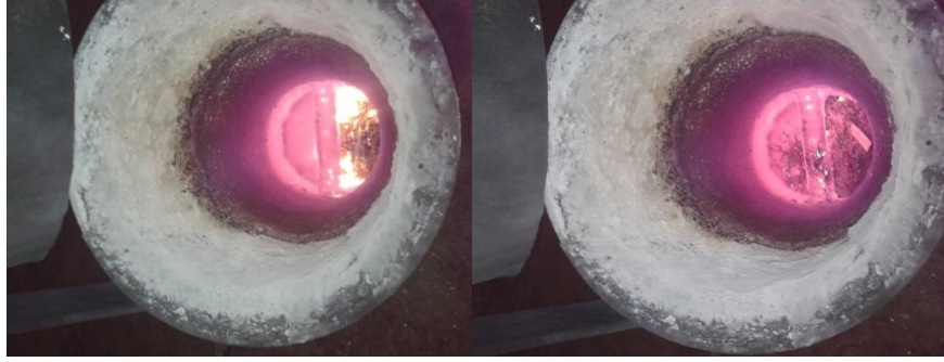
Resim 5.1. Mg tretmanı için potaya ilave edilen mg ve kullanılan örtü malzemesi (sandviç metodu).
