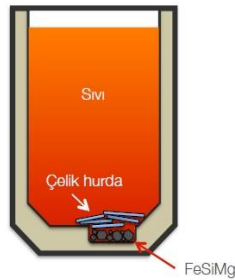
Şekil 3.17. Sandviç yönteminin şematik gösterimi
