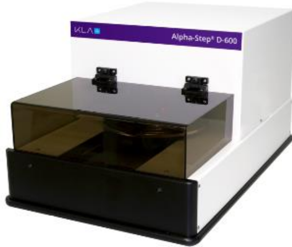
Şekil 6.2. KLA TENCOR marka Alpha-Step D-600 Stylus Profiler model yüzey pürüzlülük ölçüm cihazı
