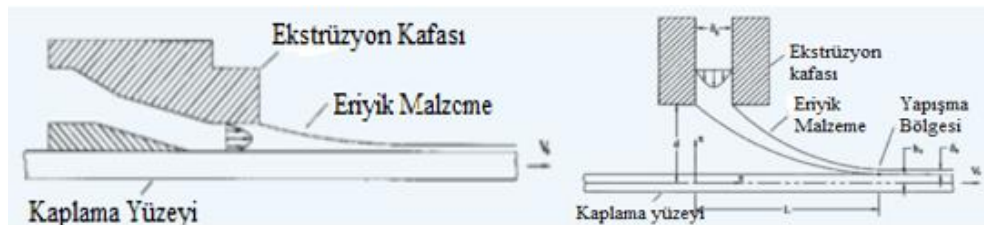
Şekil 2.7. Ekstrüzyon kaplama sisteminde dik ve yatak konum
