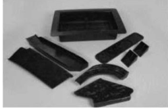
Şekil 2.17. HexMC parçaları: pencere çerçeveleri, braketler, bağlantı parçaları, köşebentler, klipsler, tavalar, Hexcel (ABD) (Koniuszewska and Kaczmar, 2016)
