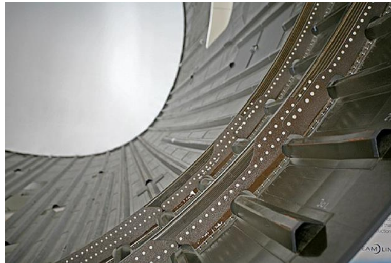
Şekil 2.19. Tipik bir modern karbon fiber / epoksi gövde bölümü (Irving and Soutis, 2015)
