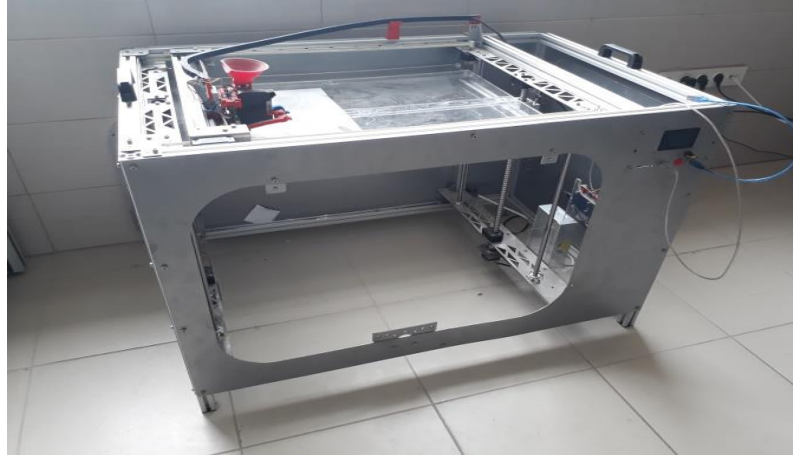
Şekil 3.1. Binder Jetting tipi 3D yazıcı.
