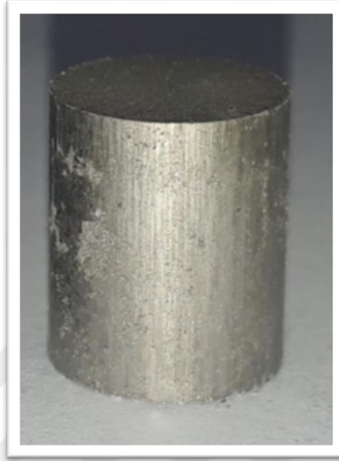
Şekil 3.5. Geleneksel yöntem ile üretilmiş test numunesi.
