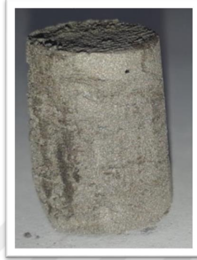
Şekil 3.6. Binder Jetting yöntemi ile üretilmiş test numunesi.
