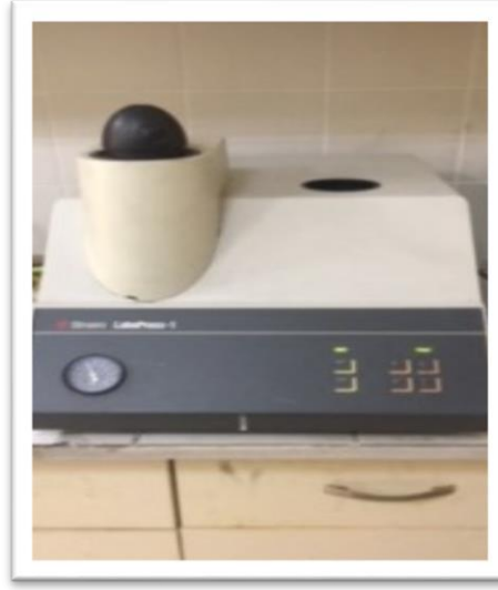
Şekil 3.9. Stuers bakalit kalıplama cihazı.
