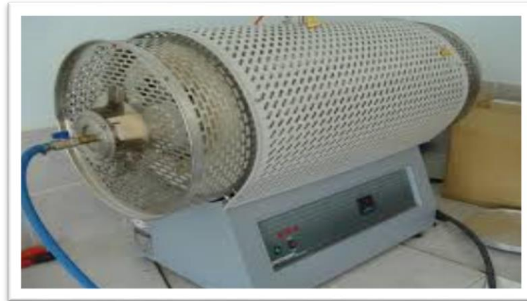
Şekil 3.7. Sinterleme işleminde kullanılan silindirik fırın.
