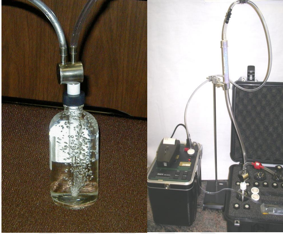
Şekil 3.3. Su örneğinin RAD 7 dedektörüne bağlanması ve su örneğinin köpürtülmesi
