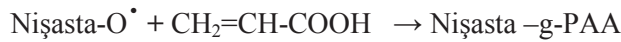
Şekil 4.3. Serbest radikal başlatıcı olarak persülfat ile nişasta üzerine AA monomerinin aşılınması için mekanizma.
