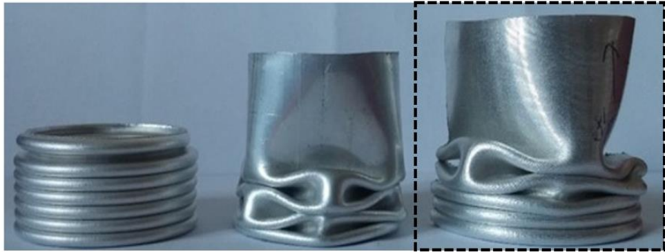
Şekil 3.1. Lokal burkulmanın gözlemlendiği ezilme kutularının görseli [7]
