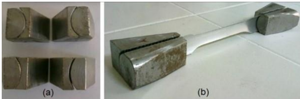
Şekil 5.2. (a) Numune sıkıştırma aparatı (b) Numunenin çenelere yerleştirilmesi [7]
