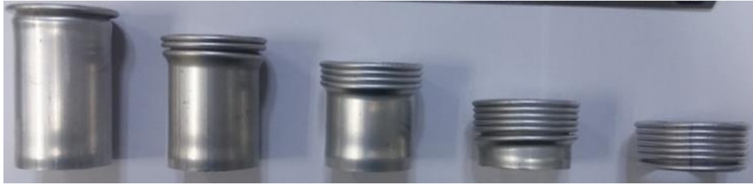
Şekil 3.2. Homojen lokal burkulma gözlenen bir ezilme kutusu [7]
