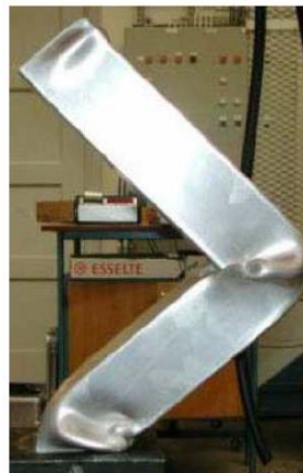
Şekil 3.3. Global burkulmaya uğramış profil görseli [1]
