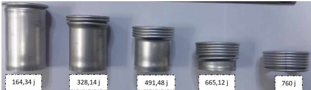
Őekil 6.3. Farklı ezilme miktarlarında 40 mm aplı tpn absorbe ettięi enerji ve oluřan deformasyon grntleri
