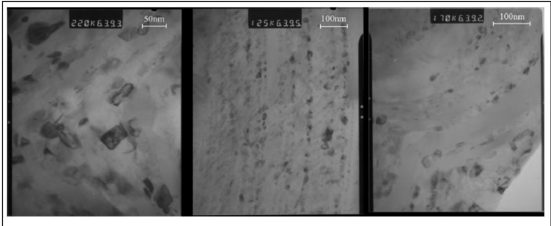
Şekil 6.13. Enine kesitte, kütlece % 6 B li ısıl işlem uygulanmış (400 °C, 1 saat) akımsız Ni-B kaplamasından elde edilen TEM mikrografları [11].
