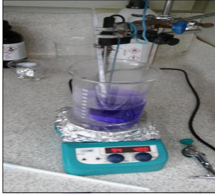
Şekil 7.2. Akımsız Ni-B kaplama banyosu ve kaplama işlemi.
