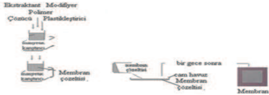
Şekil 3.3. Polimer içerikli membran hazırlanma şeması (Membran 3)
