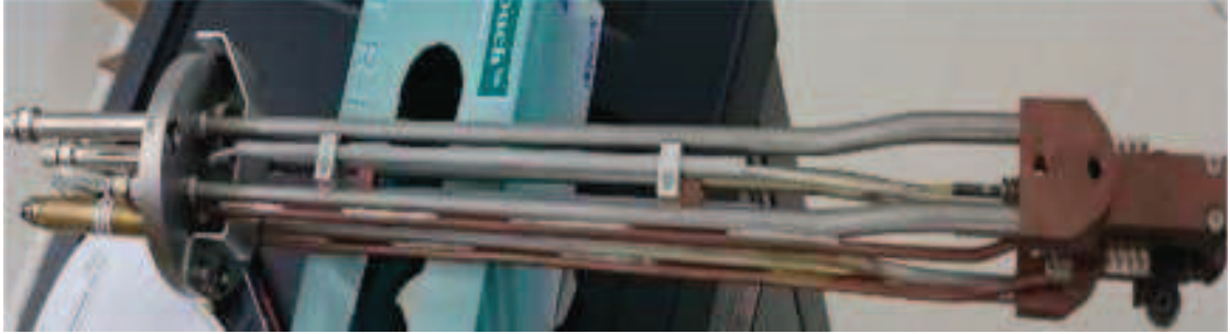
Şekil 3.3. Cihaz üzerindeki iyon kaynağı paraçası
