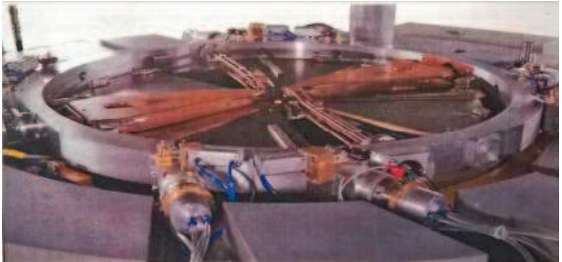
Şekil 3.8. Rf Dee'leri (180 o karşılıklı duran bakır bölge)
