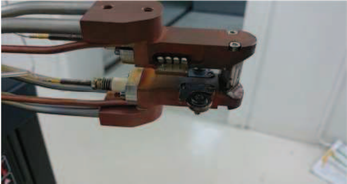
Şekil 3.4. İyon kaynağının dışarıdan bir kesiti
