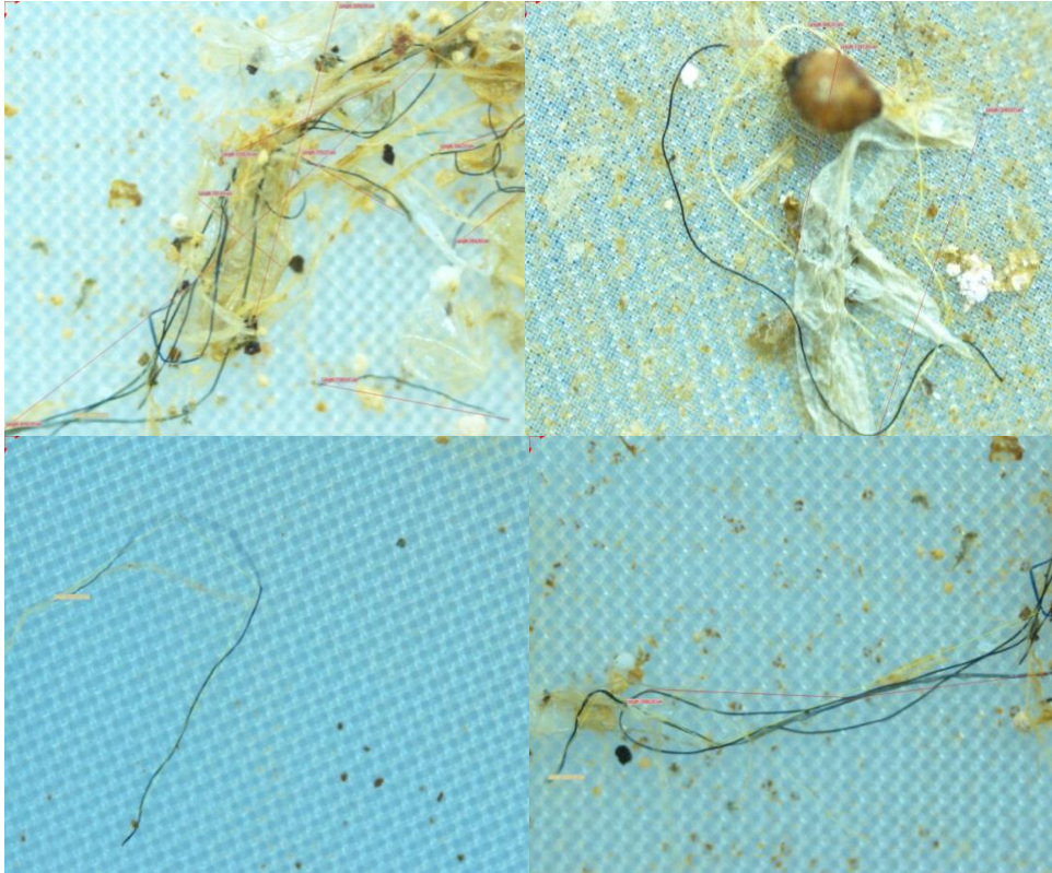
Şekil 3.11. Çamur numunelerinde bulunan mikroplastikler
