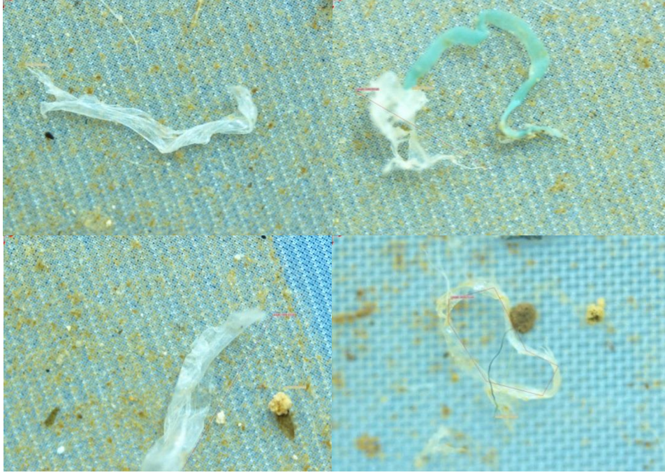
Şekil 3.10. Atıksu numulerinde bulunan film şeklinde mikroplastikler
