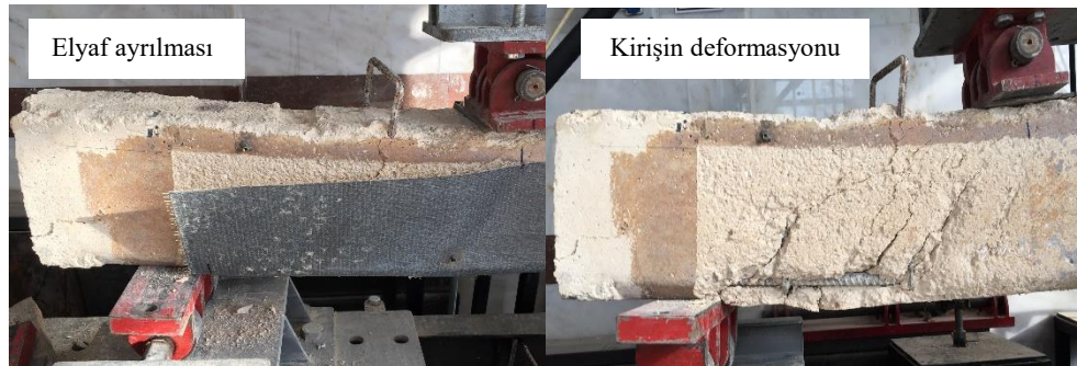
Şekil 4.18. SBS90/0 kiriş numunesinin yüklemeye sonrası deformasyon şekilleri
