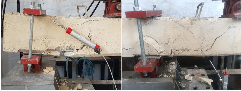
Şekil 4.2. Kontrol kirişin yükleme sonrası deformasyon şekli
