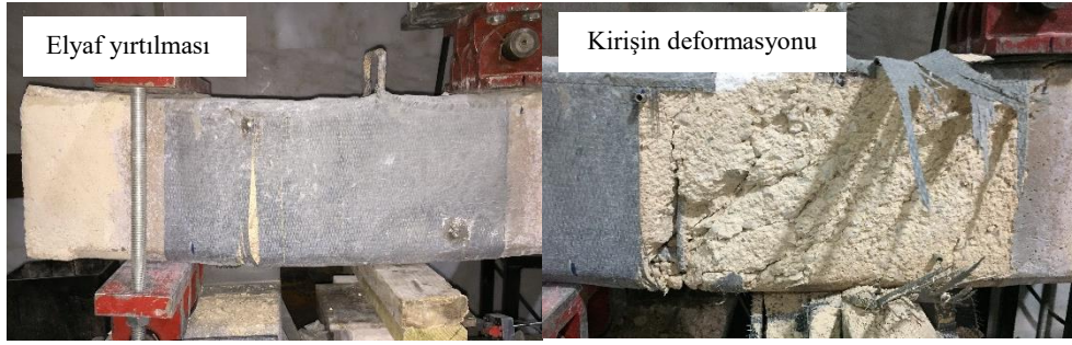
Şekil 4.22. FSW90 kiriş numunesinin yükleme sonrası deformasyon şekilleri
