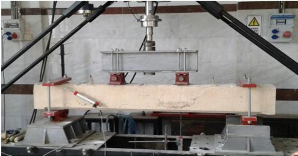
Şekil 4.1. Kontrol kirişin eğilme deneyi
