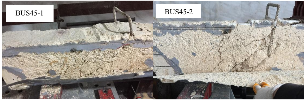
Şekil 4.10. BUS45 kiriş numunelerinin yükleme sonrası deformasyon şekilleri
