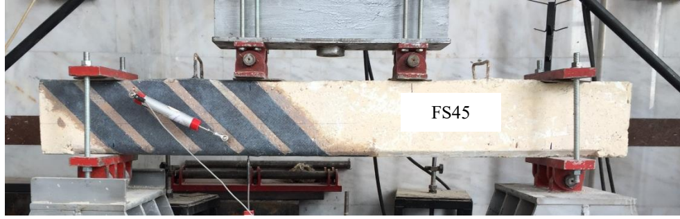
Şekil 4.13. FS45 kiriş numunelerinin eğilme deneyi
