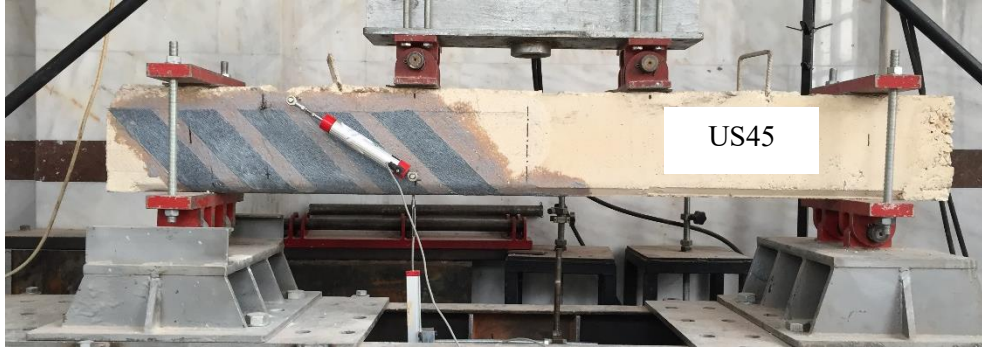
Şekil 4.5. 45US kiriş numunelerinin eğilme deneyi
