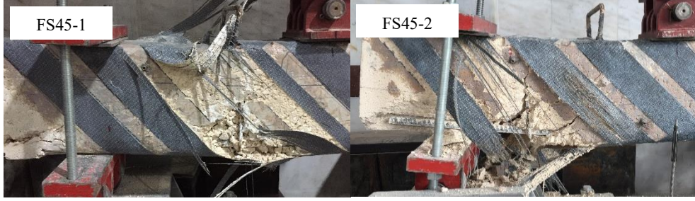
Şekil 4.14. FS45 kiriş numunelerinin yükleme sonrası deformasyon şekilleri
