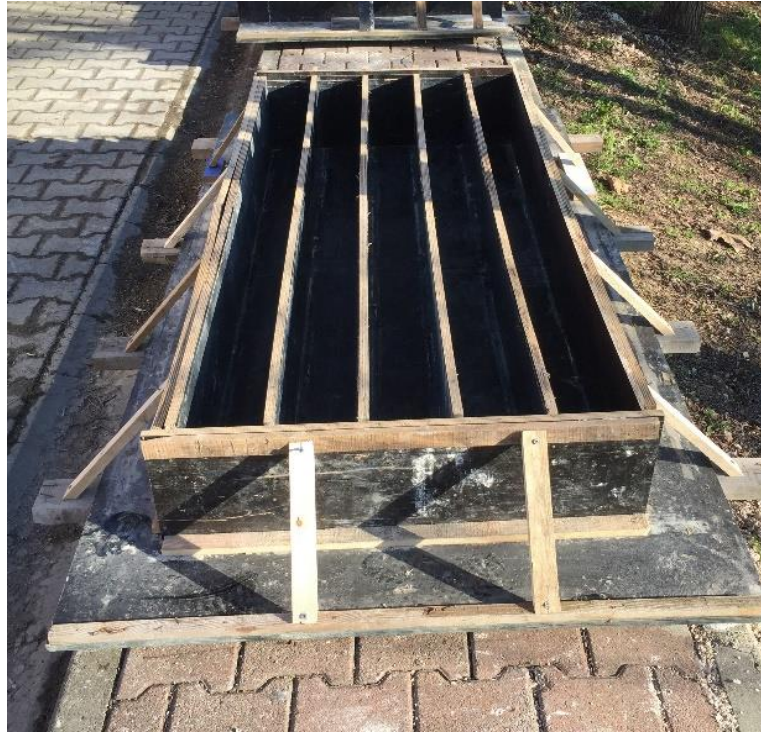
Şekil 3.11.Kiriş numuneleri için üretilen kalıp sistemi
