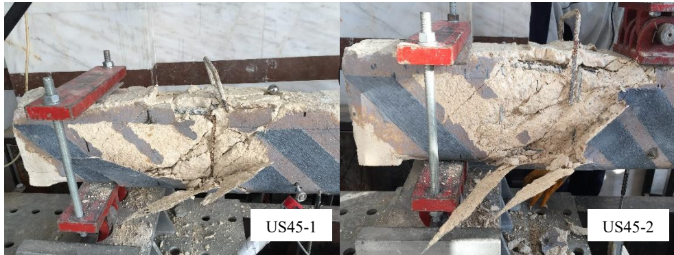
Şekil 4.6. US45 kiriş numunelerinin yükleme sonrası deformasyon şekilleri
