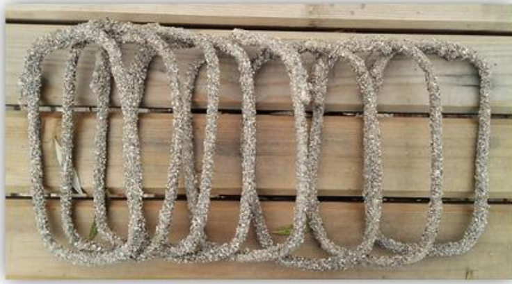
Şekil 3.7. Nervürlü-kumlu dikdörtgen etriyeleri
