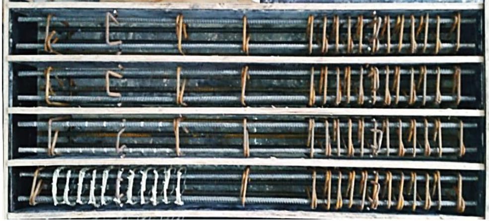
Şekil 3.19. Referans kiriş numunelerinin ve 50 mm aralıklı nervürlü GFRP etriyeli kiriş numuneleri
