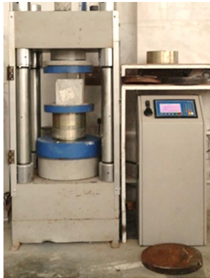
Şekil 3.1. Beton pres makinesinde basınç deneyi
