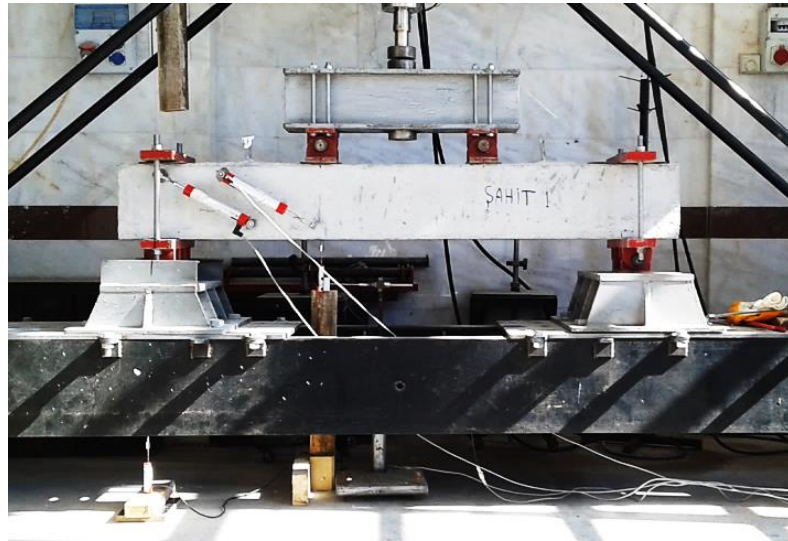
Şekil 4.1. Referans kiriş dört nokta eğilme deneyinde test edilmesi
