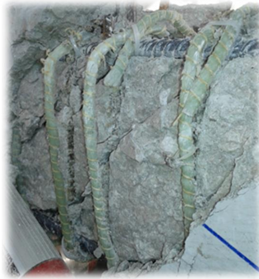
(b) GK75 No.1 numunesinde kum tabakası beton ile ayrılması
