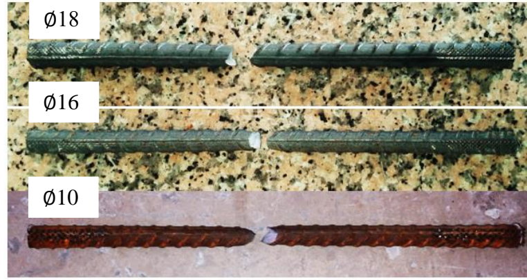
Şekil 3.3. Çekme deneyinde Ø10, Ø16 ve Ø18 donatıların kopma şekli
