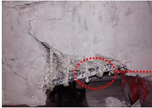
(c) GN50 no.3 kiriş numunesi yenilme şekli ve detayı
