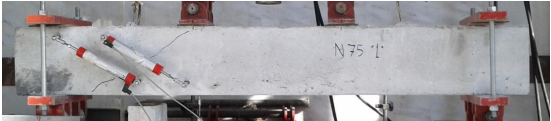
Şekil 4.11. GN75 kiriş dört nokta eğilme deneyinde test edilmesi
