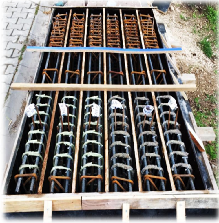
Şekil 3.18. Nüvürlü ve kumlu GFRP etriyeli 75 mm aralıklı numune kirişlerinin görünümü
