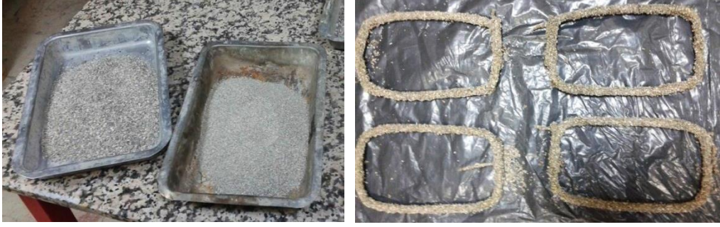
Şekil 3.6. Kum karışım bileşenleri ve kumlanan GFRP etriyeler
