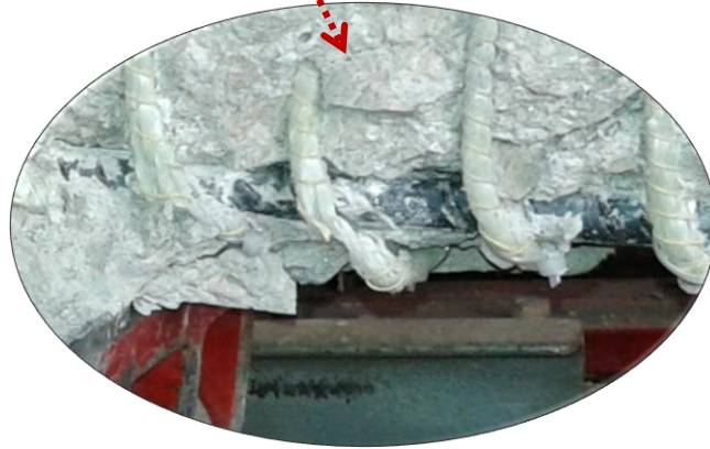
(b) GN50 no.2 kiriş numunesi yenilme şekli ve detayı
