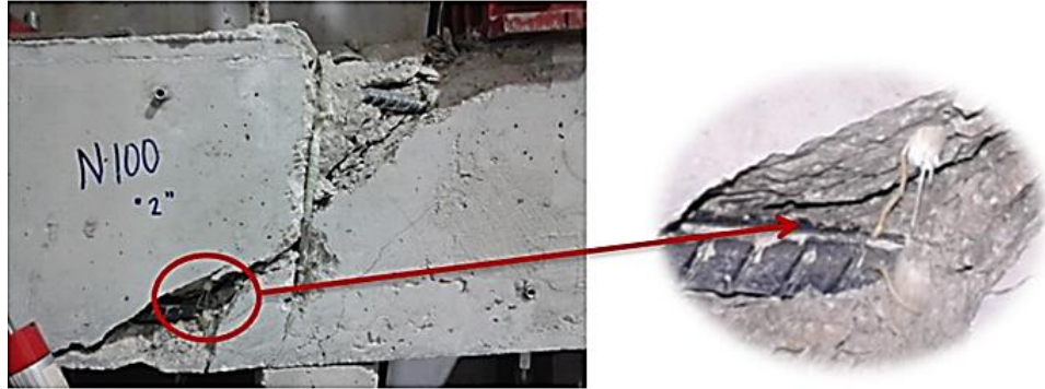
(b) GN100 No.2 kiriş numunesinin kopma biçimi ve detayı
