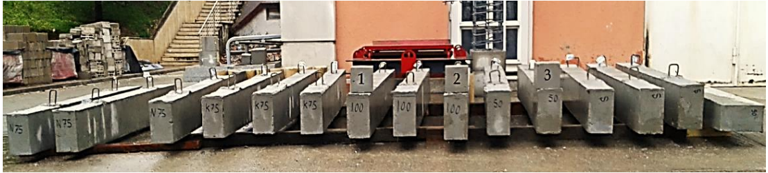
Şakil 3.22. Kiriş numuneleri kalıptan çıkarıp kür edilmesi
