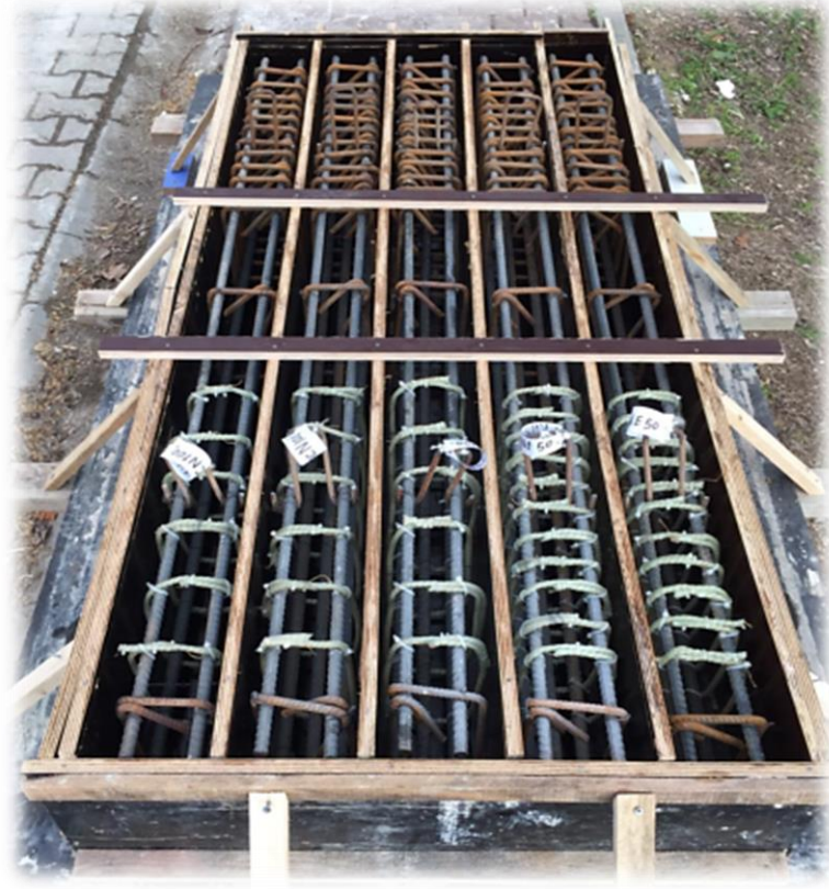
Şekil 3.17. Nüvürlü GFRP etriyeli 50 mm ve 100 mm aralıklı kiriş numunelerinin görünümü
