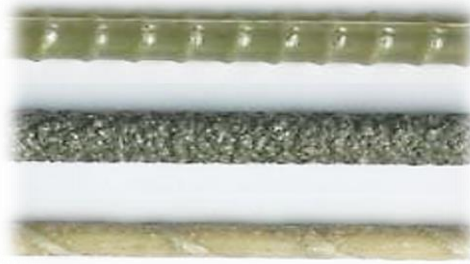
Şekil 2.9. Nervürlü, kumlu ve Sargılı-kumlu FRP donatılar (Nanni ve ark., 2014)
