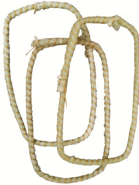
Şekil 3.4. Nervürlü dikdörtgen etriyeler
